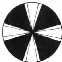
Abb. 23. Schwingung 4. Ordnung schlecht abgestimmt
