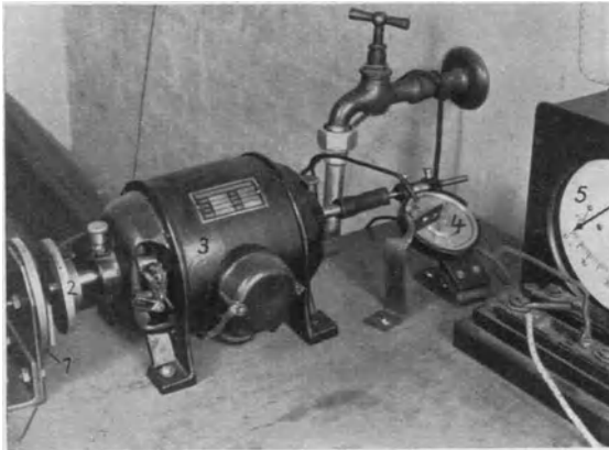
Abb. 35. Unterbrecher mit Antriebsmotor und Kontaktgeber
