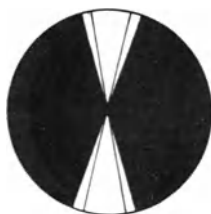
Abb. 21. Schwingung 2. Ordnung noch nicht in Resonanz
