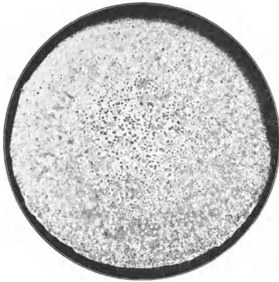
Abb. 101. Geätzter Gesamtquerschnitt durch Tiegeltemperguß.
