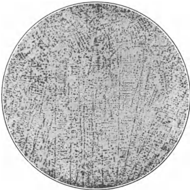
Abb. 140. Phosphorätzung (Stahlguß mit 0,46% C). Vergr. 5.
