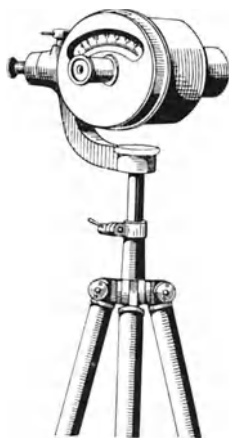
Abb. 264. Strahlungs-pyrometer „Pyro“ von Dr. R. Hase, Hannover.
