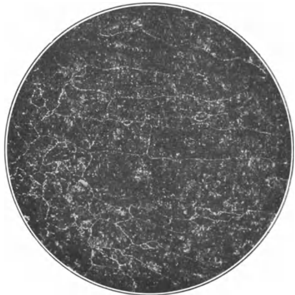
Abb. 141. Kohlenstoffätzung (Stahlguß mit 0,46% C). Vergr. 5.
