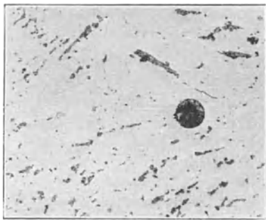
Abb. 71. Elektroflußeisen, Probe vor dem letzten Block entnommen, gegossen, geätzt. V = 100 .
