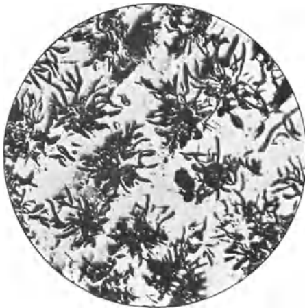
Abb. 43 v = 117 Keimwirkung im grauen Gußeisen.
