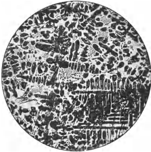
Abb. 78. Temperrohguß. Mischkristalle und Ledeburit. Vergr. 100.
