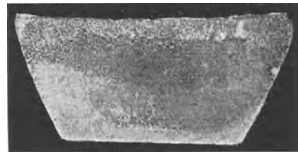
Abb. 116. Entmischung einer mäßig langsam erstarrten Blei-Antimonlegierung.
