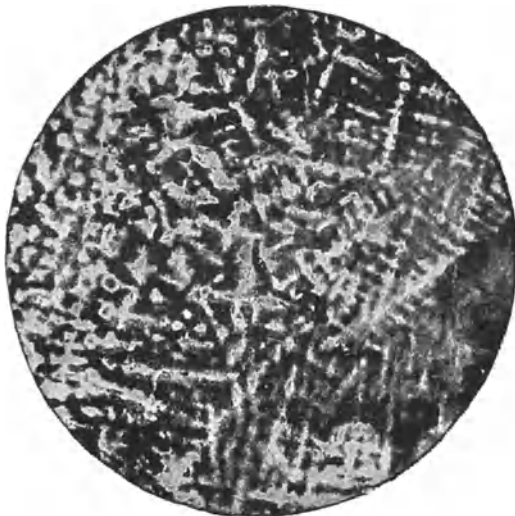
Abb. 132. Schichtkristalle in einer Eisen-Phosphorlegierung mit 0,8% P. Vergr. 4.
