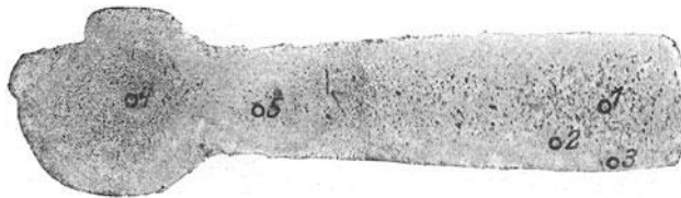
Abb. 82. Querschnitt durch einen Schlüsselbart. Vergr. 3.
