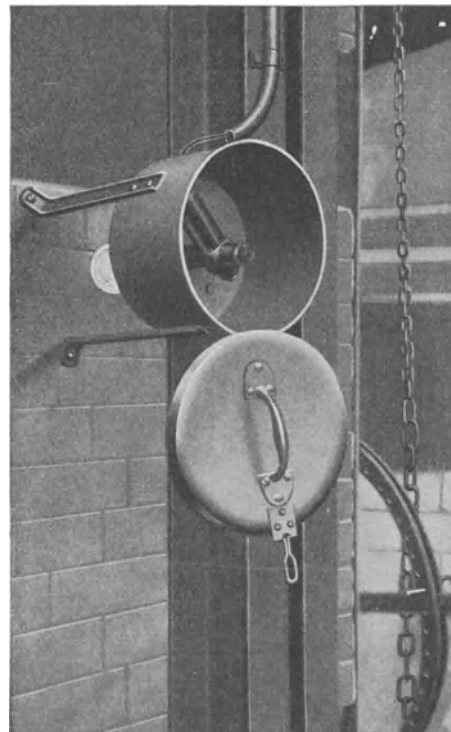
Abb. 265. Anordnung des Pyrometers im Ofenschauloch.
