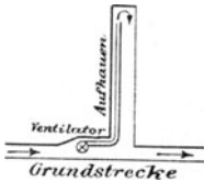
Fig. 149. Anschluß der Sonderbewetterung an den Hauptstrom.
