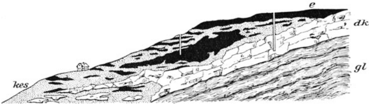
Fig. 11. Epigenetische Eisenerzlager-, Stöcke und -Nester auf Elba. Nach Fabri. e Erz, dk dolomitischer Kalkstein, gl Glimmerschiefer, ees Kalk-Eisen-Silikatgestein.
