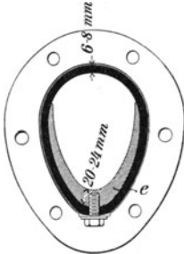
Fig. 111. Spülrohr mit eiförmigem Querschnitt und Walzeiseneinlage.
