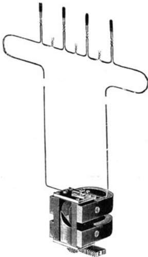
Fig. 67. Magnetelektrische Zündmaschine ohne Gehäuse.
