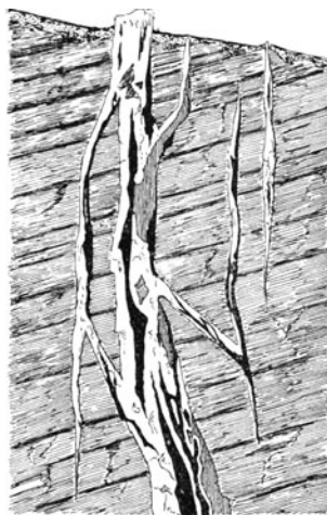
Fig. 10. Idealprofil eines Erzganges.
