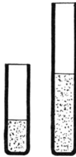
Fig. 64. Sprengkapseln Nr. 3 u. 8.
