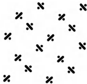
Abb. 10. Figuren im vierteligen Kreuzköperversatz.
