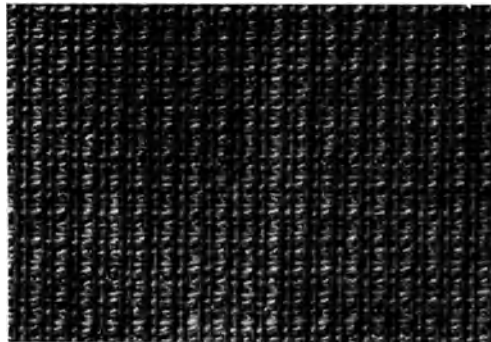
Abb. 129. Warenbild der Geweberückseite eines einpoligen Kunstseidesamtes nach Abb. 118 gewebt.
