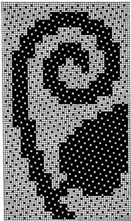
Abb. 70. Fadenverkreuzung eines Damastgewebes bei 4fädiger Jacquardaushebung und Schußfortschritt in 8bindigem Atlas gewebt.
