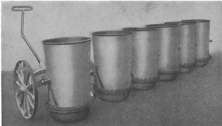
Abb. 119. Normalschmelzkessel mit Abfahrwagen. (Sommer-Schmidting-Werke, Düsseldorf.)
