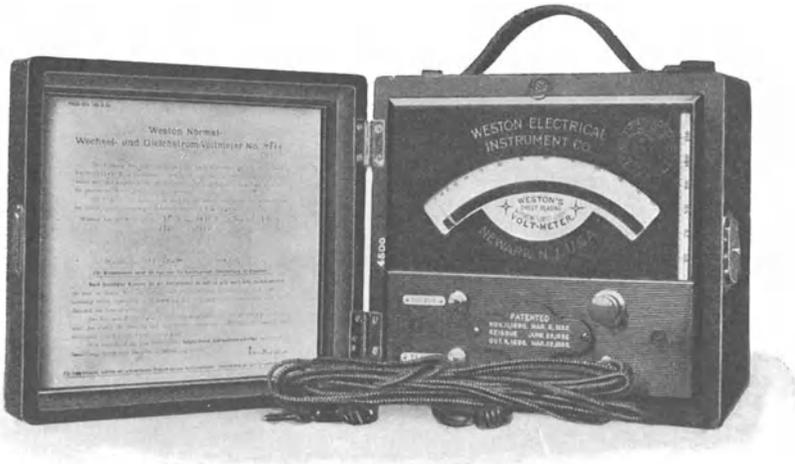
Fig. 255. Elektrodynamisches Voltmeter von Weston für direkte Ablesung.
