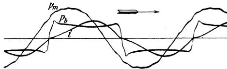
Fig. 381. Strom, Spannung am Lichtbogen und an der Maschine bei vorgeschalteter Drosselspule, bei Homogenkohlen.
