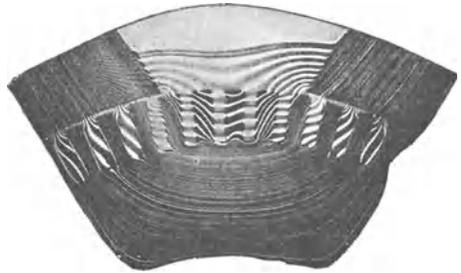
Fig. 324. Kraftlinienverlauf in einem gezahnten Anker.
