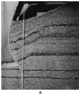
Abb. 32. Erddruckversuch II mit sehr nachgiebiger Wand.
