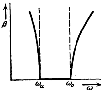
Abb. 574. Dämpfungskurve des Kettenleiters nach Abb. 573.
