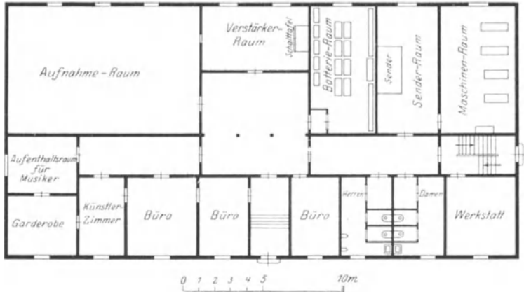
Abb. 1056. Grundriß einer Rundfunksenderanlage.
