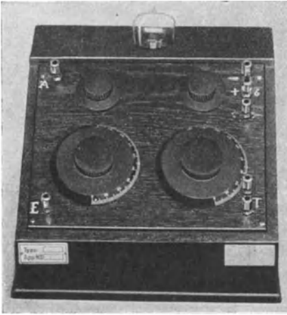
Abb. 963. Audionsekundärempfänger (Schaltung nach Abb. 964).
