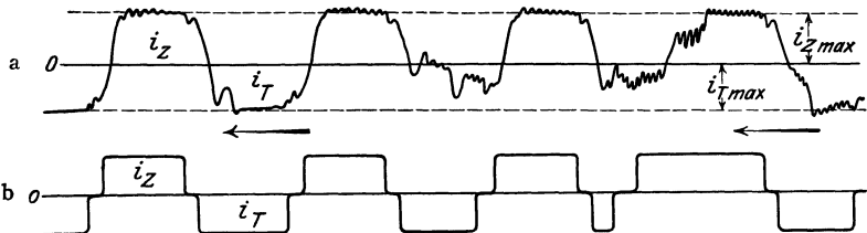
Abb. 579. Selektionswirkung von Relais. a Stromkurve im steuernden Kreis, b Stromkurve im gesteuerten Kreis.
