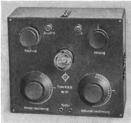
Abb. 968. Rückkopplungsempfänger (Schaltung nach Abb. 969).
