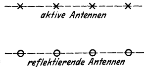
Abb. 1104. Antennenkombination mit Richtwirkung und Reflexion.
