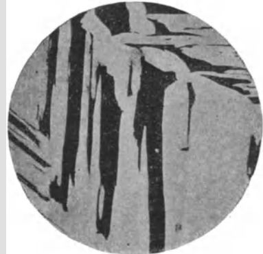
Fig. 133. 67% Cu + 33% Sn. Vergrößerung 48 fach. (Zu Seite 240.)
