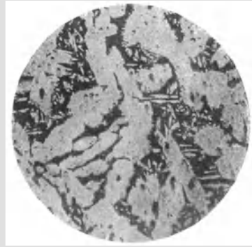
Fig. 92. 90% Cu + 10% Al. Bei 600° abgeschreckt. Vergrößerung 50fach. (Zu Seite 124.)
