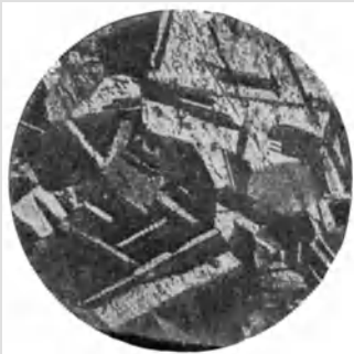
Fig. 87. 97% Cu + 3% Al. Ver- größerung 200 fach. (Zu Seite 124.)
