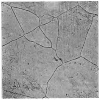
Fig. 19. 70% Cu + 30% Ni. Langsam erstarrt. Vergrößerung 65fach. (Zu Seite 12.)
