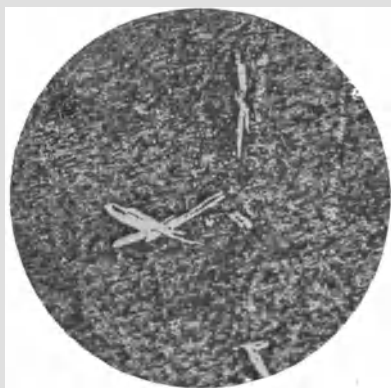
Fig. 210. Zink mit 0,12% Fe. Vergrößerung 160 fach. (Zu Seite 471.)
