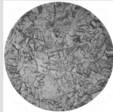
Fig. 142. Unbearbeitete Bronze ausgeglüht. Vergrößerung 200fach. (Zu Seite 257.)
