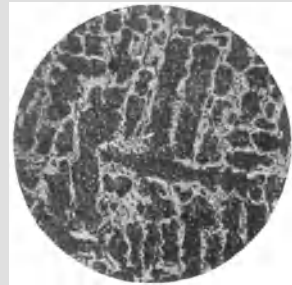
Fig. 33. Probe von Fig. 31, nochmals bei 135° gegläht. Vergrößerung 85 fach. (Zu Seite 18.)
