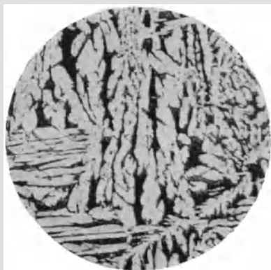
Fig. 148. 59% Cu + 41% Zn. Vergrößerung 200 fach. (Zu Seite 310.)
