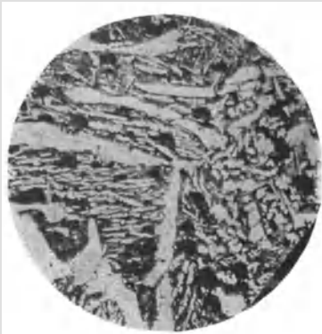
Fig. 93. 90% Cu + 10% Al. Bei 750° abgeschreckt. Vergrößerung 50fach. (Zu Seite 124.)
