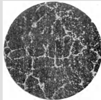
Fig. 90. 10% Cu + 90% Al. Ver- größerung 68 fach. (Zu Seite 124.)
