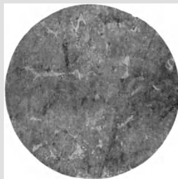
Fig. 144. 85% Cu + 9,5% Sn + 5,5% Zn. Vergrößerung 200 fach. (Zu Seite 297.)
