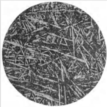
Fig. 96. 90% Cu + 10% Al. Bei 950° abgeschreckt. Vergrößerung 50fach. (Zu Seite 124.)
