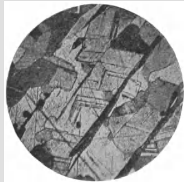
Fig. 97. 90% Cu + 10% Al. Bei 900° abgeschreckt. Vergrößerung 150fach. (Zu Seite 124.)
