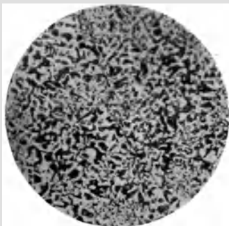
Fig. 89. 32,5% Cu + 67,5% Al. Ver- größerung 68 fach. (Zu Seite 124.)
