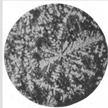
Fig. 99. 70% Al + 30% Mg. Vergrößerung 40fach. (Zu Seite 150.)
