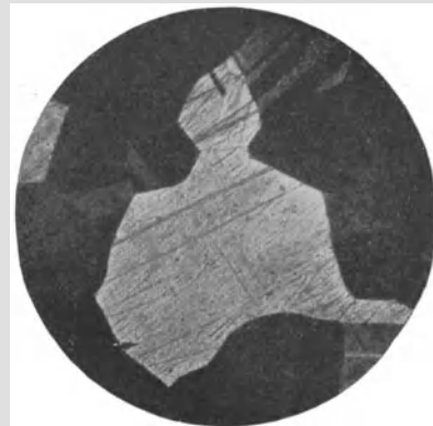
Fig. 166. Gefüge des bei 725° geglühten Messings. Vergrößerung 85 fach. (Zu Seite 335.)
