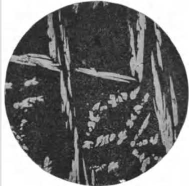
Fig. 132. 77% Cu + 23% Sn bei 530° abgeschreckt. Vergrößerung 18 fach. (Zu Seite 240.)
