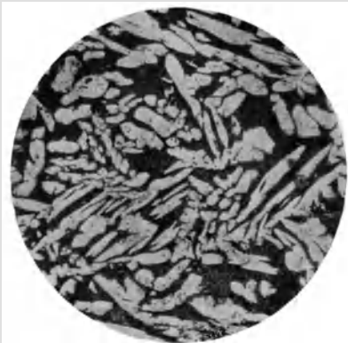
Fig. 170. 56% Cu + 42% Zn + 2% Ni. In Kokille gegossen. Vergrößerung 57 fach. (Zu Seite 363.)
