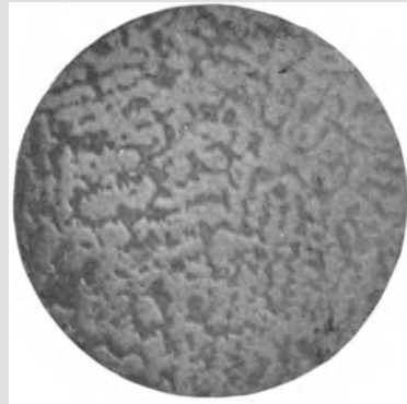
Fig. 101. 40% Al + 60% Mg. Vergrößerung 40fach. (Zu Seite 150.)
