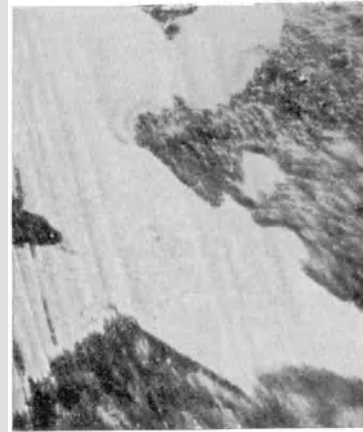
Fig. 84. 50% Cu + 50% Zn. Zusammengepreßt u. auf 400° erhitzt. Vergrößerung 120 fach. (Zu Seite 93.)
