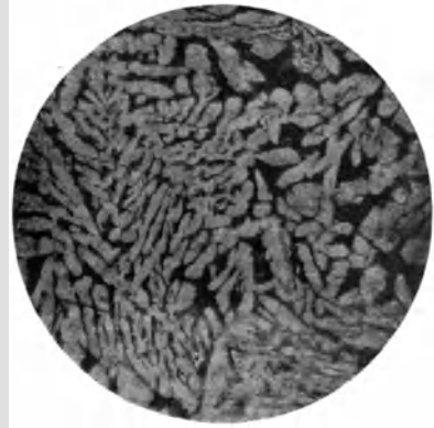
Fig. 171. 54% Cu + 41% Zn + 5% Ni. In Sand gegossen. Vergrößerung 30 fach. (Zu Seite 363.)
