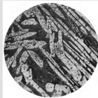
Fig. 88. 89,5% Cu + 10,5% Al. Ver- größerung 200 fach. (Zu Seite 124.)
