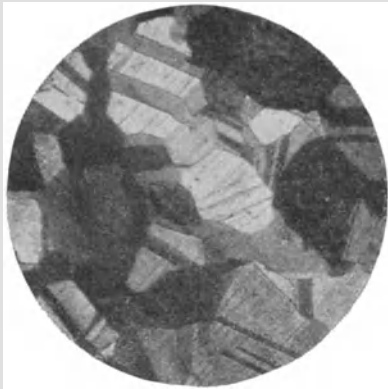
Fig. 156. Gefüge des ausgeglühten Messings. Vergrößerung 85 fach. (Zu Seite 329.)
