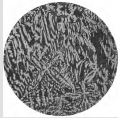
Fig. 131. 77% Cu + 23% Sn bei 560° abgeschreckt. Vergrößerung 18 fach. (Zu Seite 240.)
