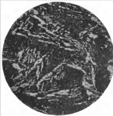
Fig. 94. 90% Cu + 10% Al. Bei 900° abgeschreckt. Vergrößerung 50fach. (Zu Seite 124.)
