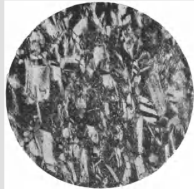
Fig. 157. Gefüge des schwach gewalzten Messings. Vergrößerung 85 fach. (Zu Seite 329.)
