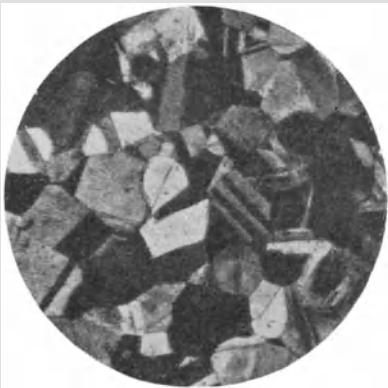
Fig. 165. Gefüge des bei 600° geglühten Messings. Vergrößerung 85 fach. (Zu Seite 335.)
