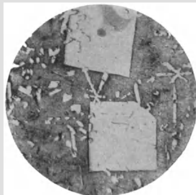
Fig. 209. 83% Sn + 11% Sb + 6% Cu. Langsam abgekühlt. Vergrößerung 117 fach. (Zu Seite 464.)
