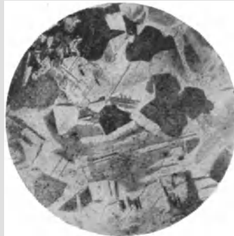
Fig. 139. Bronze durch Reibung gehärtet und gegläht. Vergrößerung 200 fach. (Zu Seite 257.)
