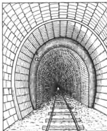
Abb. 169. Ansicht der Ringdüse vom Portal aus.
