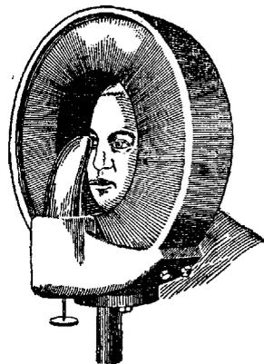
Рис. 11. Внутриполюсный электромагнит Меллингер-Клингельфуса.
