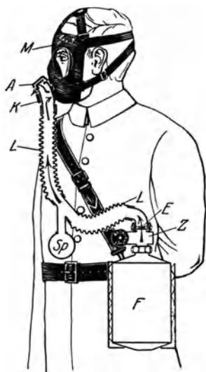
Abb. 71. Dräger-CO-Filter mit mechanischem Zeitmesser. (Schematisiert.)
