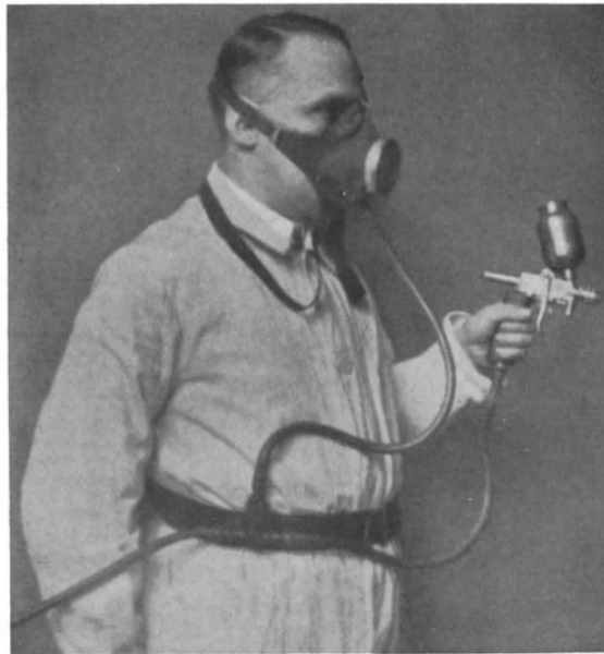
Abb. 66. Schlauchgerät mit Anschluß an die Druckluftleitung der Farbspritzpistole. (Auer-Gesellschaft.)
