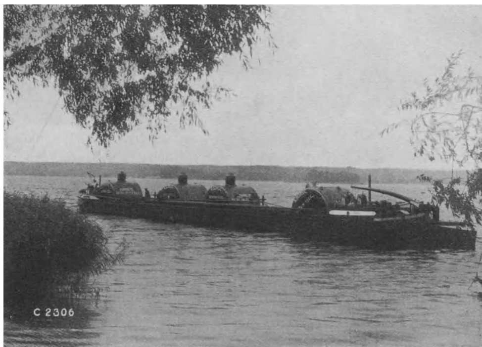
Abb. 16. 4 Schiffskessel von 4,4 m \varnothing , die für den Eisenbahntransport zu groß sind, werden zu Wasser transportiert.
