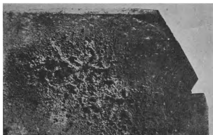
Abb. 23. Korrosion an einem Turbinen-Propeller.
