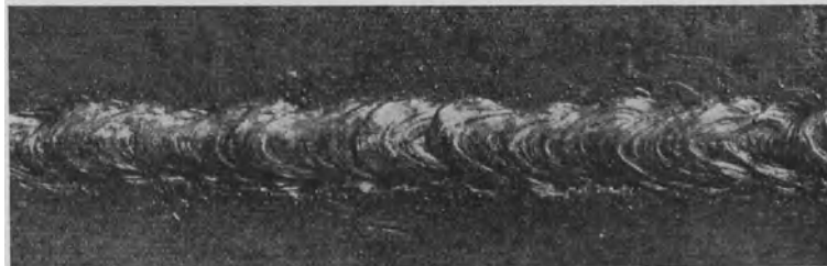
Abb. 18. V-Naht an 6 mm starken Blechen mit einfacher Schmelzlage.
