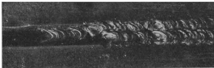
Abb. 19. V-Naht an 15 mm starken Blechen mit dreifacher Schmelzlage.
