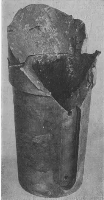
Abb. 19. Torsionsbruch einer U-Bootwelle.
