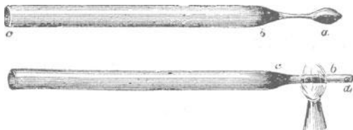
Abb. 470 u. 471. Arsenreduktionsröhrchen. a Arsenige Säure. b Kohle- splitterchen. c Arsenspiegel.
