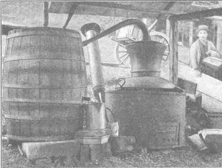
Abb. 423. Destillierapparat zur Gewinnung des Edeltannenzapfenöles in der Schweiz.
