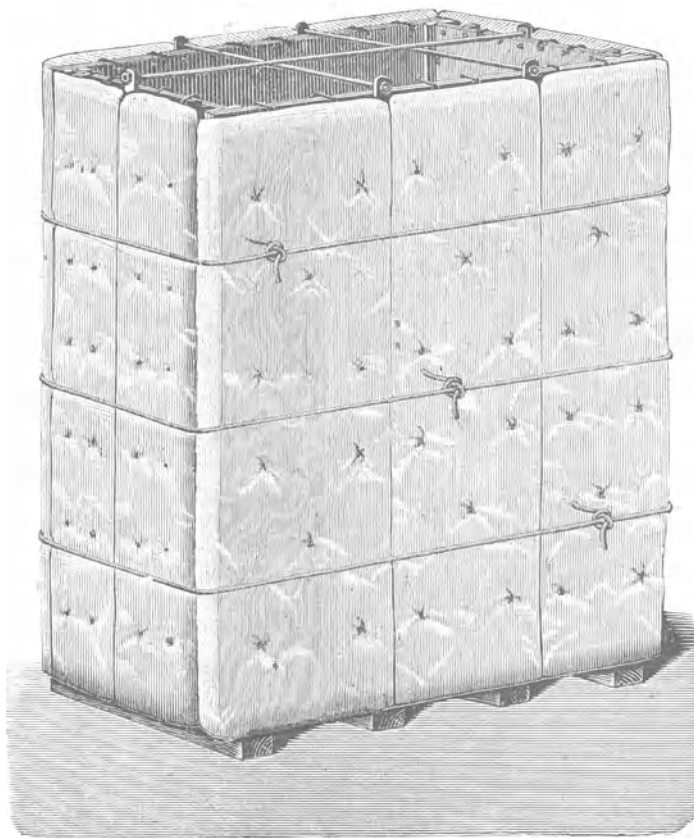
Abb. 498. Schmiedeeiserne Seifenform mit Werg-Matratzenumhüllung.
