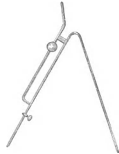
Abb. 16. Heber mit seitlich an- gesetztem Saugrohr.
