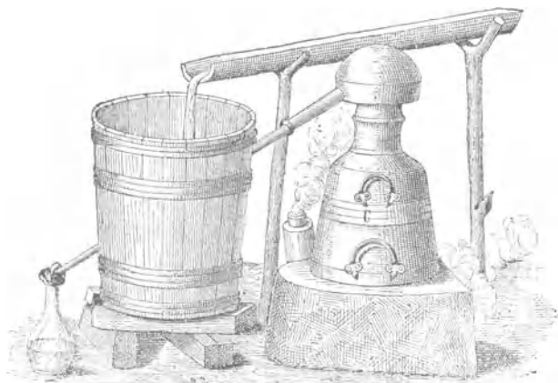
Abb. 422. Destillierapparat für Rosenöl in Bulgarien.
