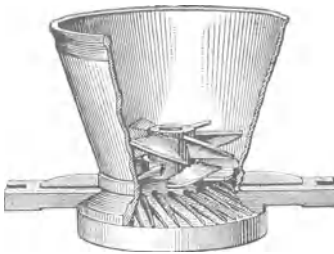
Abb. 552. Farbmühlentrichter mit Schaufelrädern.
