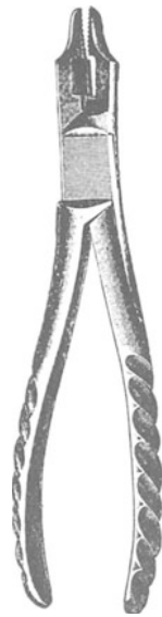
Abb. 369. Drahtzange zum Abschneiden, Fassen und Zusammen-drehen von Metall-drähten.
