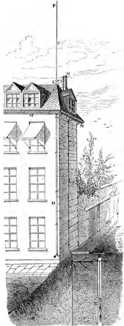
Fig. 350. Führung der Leitung.
