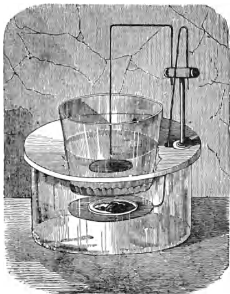
Fig. 380. Einfacher galvanoplastischer Apparat.
