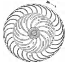
Fig. 175. Horizontaldurchschnitt des Laufrades.
