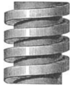
Fig. 21. Schraubenspindel mit vierseitigem Querschnitt des Ganges.
