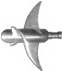
Fig. 30. Doppelgängige Schiffschraube. Kennies Fischschwanzform.
