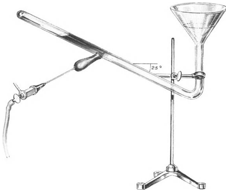
Abb. 5. Modellversuch: Eine Flüssigkeit läßt sich auf eine schwerere, durch Luft begrenzte Flüssigkeit ohne weiteres sauber schichten. (Nach KIRSCHNER: Arch. klin. Chir. 1932, Kongreß-Bd.)
