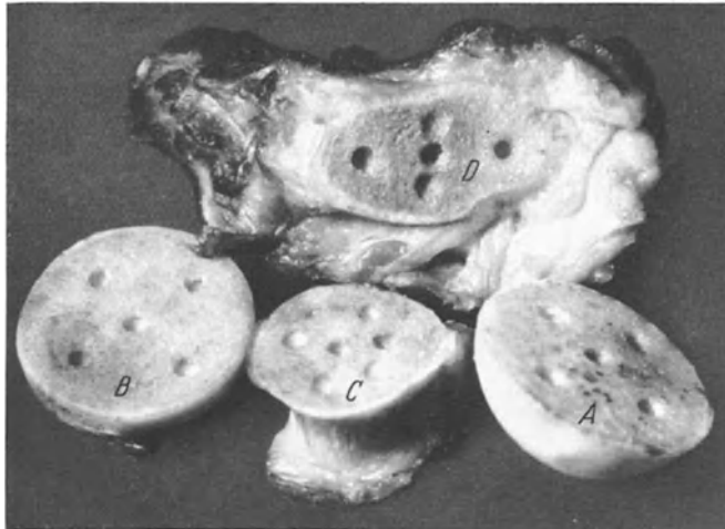
Abb. 28. Prüfungsstellen der Bruchfestigkeit des Knochens. A Caput: Richtung medialwärts. B Caput: Richtung lateralwärts. C Caput-Collumgrenze: Richtung lateralwärts. D Collumbasis, Richtung: lateralwärts.
