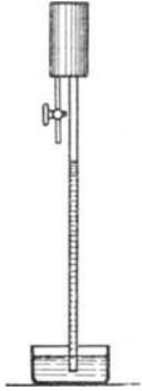
Abb. 231. Vorrichtung (unglasiertes Tongefäß) zum Nachweis des Unterschiedes der Diffusionsgeschwindigkeit von Luft und Wasserstoff.
