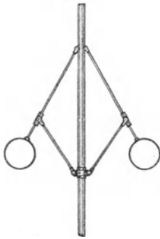
Abb. 79. Zentrifugalregulator der Dampfmaschine.
