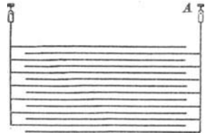
Abb. 377. Schema eines zusammengesetzten Kondensators.
