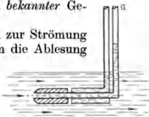
Abb. 176. PITOT-Rohr (nach PRANDTL), ein Staugerät zur Messung des Druckes in strömender Flüssigkeit.
