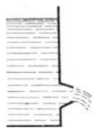
Abb. 181. Ein Stutzen an der Ausflußöffnung beeinflusst die Ausflußmenge.
