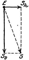
Abb. 111. Zum Verhalten der Drehwaage von Eötvös. E das Balkenende (von einem Auge gesehen, das in der Verlängerung des Balkens liegt), S die Schwerkraftichtung, die mit der Normalebene einen Winkel bildet, S_v ihre vertikale Komponente, die in die Normalebene fällt, S_h ihre Horizontalkomponente, die den Balken senkrecht in der Horizontalebene angreift und aus der Ruhelage herausdreht. Der Winkel zwischen S und S_v ist der, um den die Schwerkraft von der Normalebene abweicht. (In der Abbildung sehr übertrieben.)
