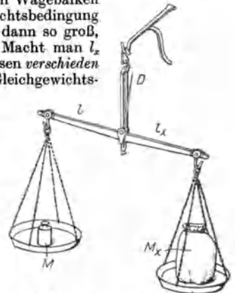
Abb. 68. Zweiarmiger Hebel als Krämerwaage.
