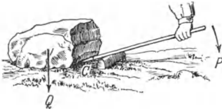
Abb. 63. Der zweiarmige Hebel als Hebebaum.
