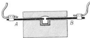
Abb. 402. Elektrischer Ofen mit Lichtbogenheizung.
