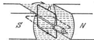
Abb. 470. Rotierender Drahtrahmen in einem Magnetfelde.
