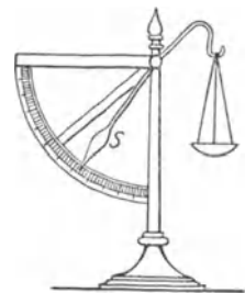
Abb. 72. Zeigerwage (automatische Wage).
