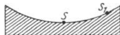
Abb. 102. Die Bewegung des Pendelkörpers ist eine Bewegung auf vorgeschriebener Bahn, vergleichbar der Bewegung eines materiellen Punktes auf der konkaven Seite eines Kreisbogens.
