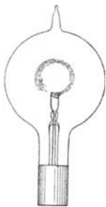
Abb. 496. Kathodenstrahlen im Magnetfeld.
