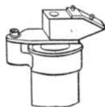
Abb. 591. Zeichenapparat (Camera lucida) mit dem Mikroskop verbunden.
