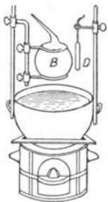
Abb. 271. Zur Messung der Dampfdichte nach DUMAS.
