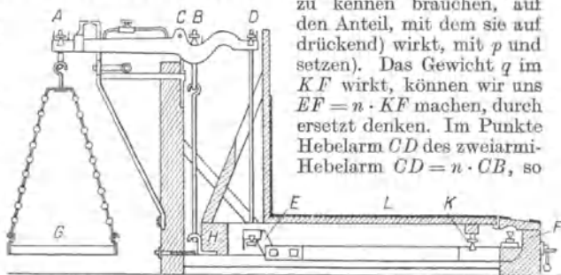
Abb. 73. Brückenwaage (Dezimal-, Zentesimalwaage).
