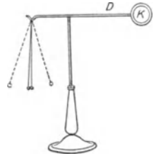
Abb. 348. Zwei pendelartig aufgehängte Körper zeigen durch ihre gegenseitige Abstoßung Ladung der Körper an (Elektroskop).
