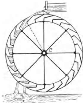
Abb. 190. Oberflächiges Wasserrad. Das Wasser bewegt das Rad durch einseitige Belastung.
