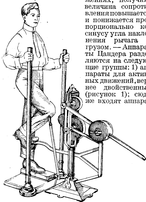
Рис. 1. Аппарат Цандера для активных движений с сопротивлением.
