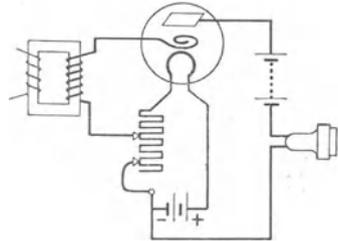
Abb. 102. Schema eines Einfach-Niederfrequenzverstärkers.
