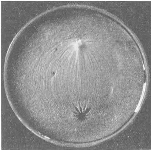
Abb. 2. Elektrisches Feld zweier entgegengesetzter Ladungen (nach Benischke).
