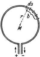
Abb. 18. Magnetfeld eines Stromkreises im Kreismittelpunkt.
