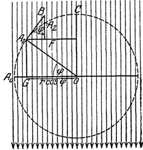
Abb. 35. Die Spannung proportional dem Sinus des Drehungswinkels.
