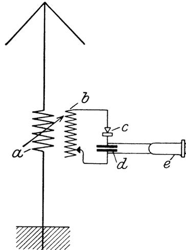
Abb. 74. Anordnung für Detektorempfang.
