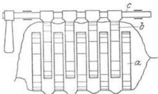
Abb. 42. Flachspulenvariometer.
