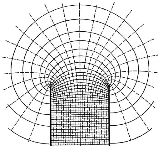
Platte (Abb. 5) die Elektrizitätsmenge  $+q$ , so gehen von ihr  $4\pi q$  Kraftlinien senkrecht zur zweiten Platte, und es besteht zwischen beiden Platten ein gleichmäßig verteiltes (homogenes) elektrisches Feld, das in Abb. 6 dargestellt ist. Die Feldstärke ist somit
