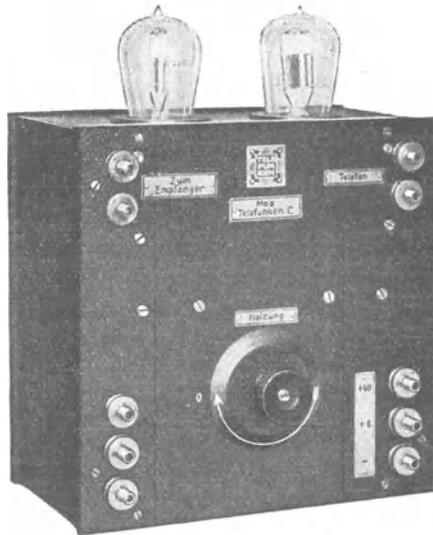
Abb. 103. Zweifach-Niederfrequenzverstärker von Telefunken.
