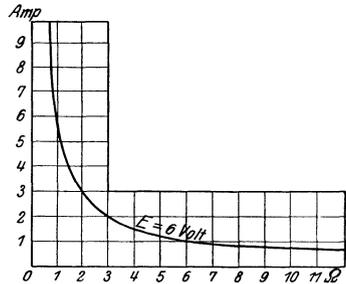
Abb. 22. Graphische Darstellung des Ohmschen Gesetzes.
