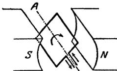
Abb. 30. Rotierender Drahtbügel im Magnetfelde.
