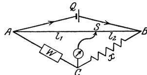
Abb. 25. Schematische Darstellung der Wheatstoneschen Brücke.
