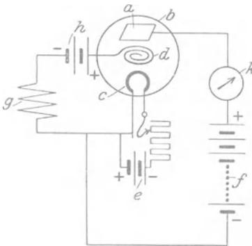
Abb. 85. Gitterstrom und Anodenstrom.
