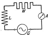
Abb. 45. Ohmscher Widerstand und Selbstinduktion im Wechselstromkreis.
