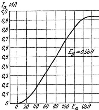
Abb. 90. Anodenstrom als Funktion der Anodenspannung.
