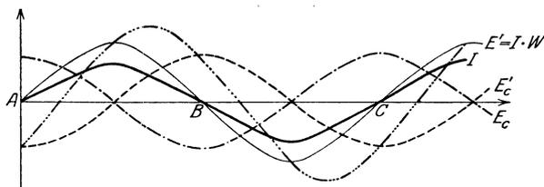
Abb. 48. Phasenverschiebung im Wechselstromkreis bei vorhandener Kapazität.
