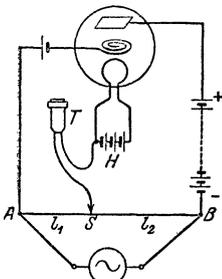
Abb. 91. Bestimmung des Durchgriffs nach der Brückenmethode.
