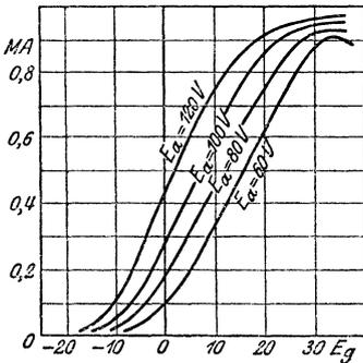
Abb. 86. Anodenstrom als Funktion der Gitterspannung.
