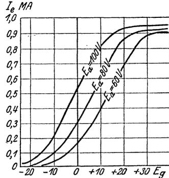
Abb. 89. Emissionsstrom als Funktion der Gitterspannung.
