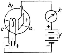
Abb. 78. Hochvakuumröhre mit zwei Elektroden.
