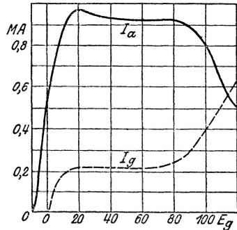
Abb. 87. Anodenstrom- und Gitterkennlinie.
