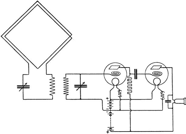
Abb. 107. Rahmenantenne in Verbindung mit einem Zweifach-Hochfrequenzverstärker.
