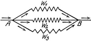
Abb. 26. Drei Widerstände in Parallelschaltung.
