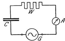
Abb. 47. Ohmscher Widerstand und Kapazität im Wechselstromkreis.
