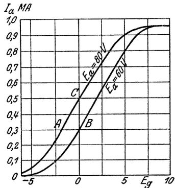
Abb. 94. Bestimmung der Größen  $D$ ,  $S$ ,  $R_i$ .
