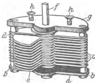
Abb. 9. Aufbau des Drehplattenkondensators.
