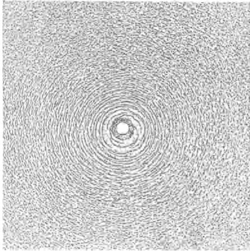
Abb. 17. Magnetfeld eines stromführenden linearen Drahtes (nach Benischke).
