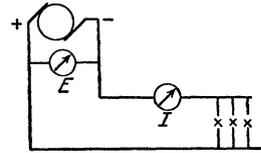
Abb. 28. Schaltungsbild für Strom- und Spannungsmesser.
