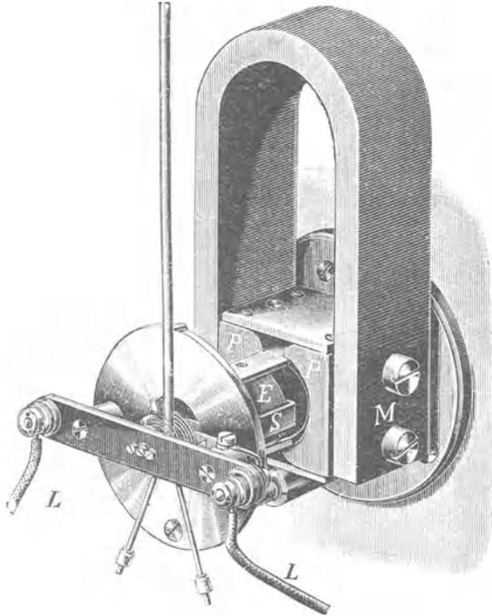
Abb. 21. Drehspuleninstrument. Der Eisenkern *E* ist aus der zylindrischen Ausbohrung der Polschule *P* herausgezogen, so daß die Drehspule *S* sichtbar wird.
