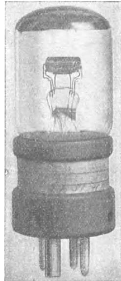
Abb. 83. Empfangsaudionröhre von Telefunken.
