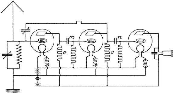
Abb. 105. Dreifach-Hochfrequenzverstärker in der Primärschaltung mit kapazitiver Rückkoppelung.
