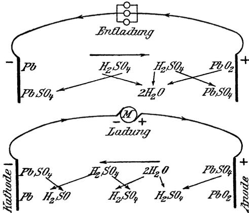
Abb. 12. Entladen und Laden eines Akkumulators (nach Benischke)<sup>1)</sup>.
