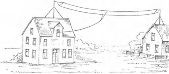
Abb. 71. Doppel-T-Antenne in richtiger Anordnung.
