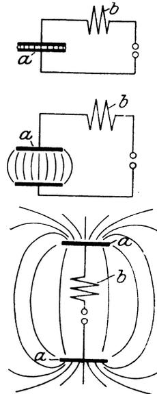
Abb. 66. Übergang vom geschlossenen zum offenen Schwingungskreis.
