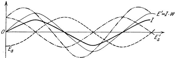
Abb. 46. Phasenverschiebung im Wechselstromkreis bei vorhandener Selbstinduktion.
