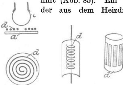
Abb. 80—82. Ausführungsformen des Gitters und der Anode.
