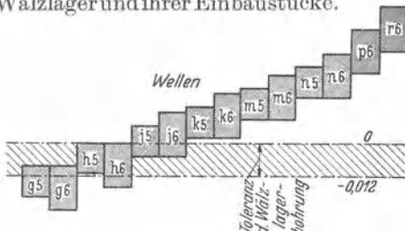
Abb. 112. Größe und Lage der ISA-Toleranzen für Zapfen von 30—50 mm Ø.
