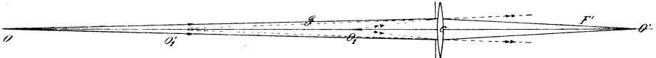
Abb. 10. Die Abbildung wirklicher Punkte O und O_1 durch eine Sammellinse C in O' (auffangbares Bild) und O'_1 (nichtauffangbares Bild); a = CO ; a_1 = CO_1 ;
