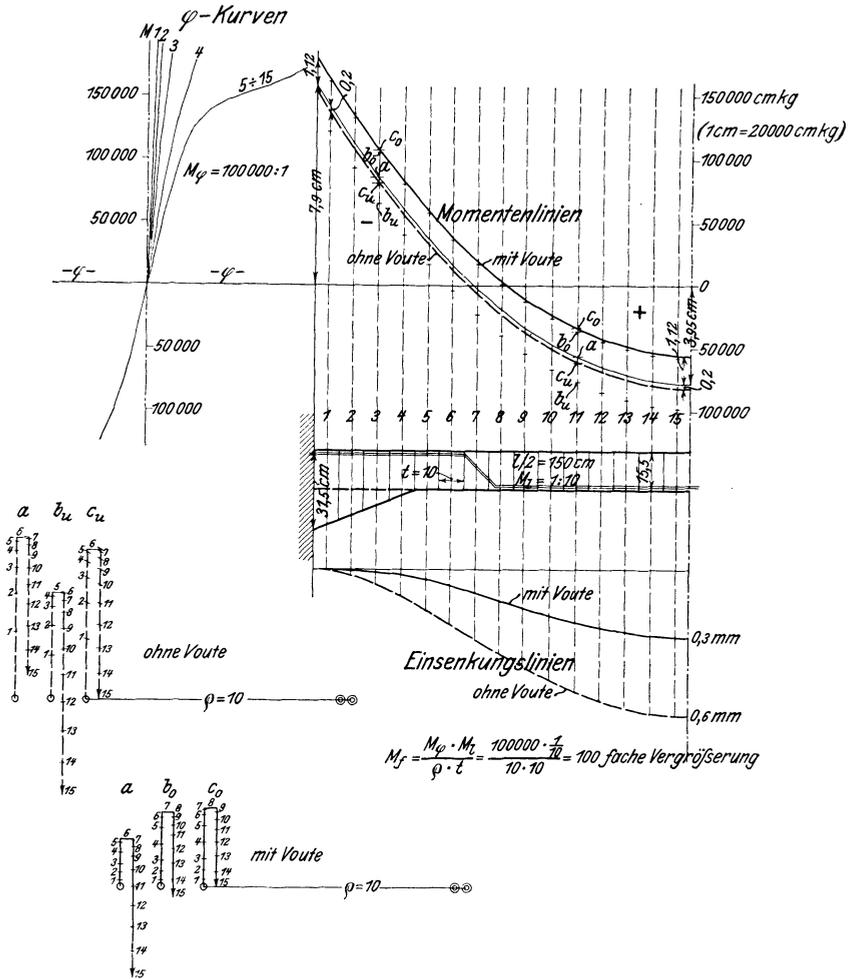
Fig. 32. Einsenkung einer **eingespannten** Platte mit und ohne Vouten.
