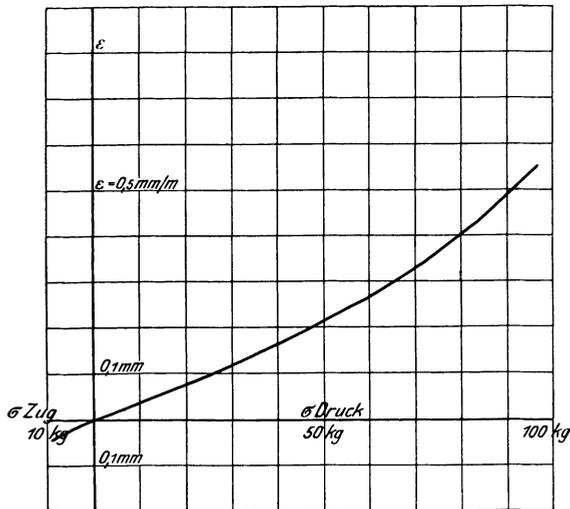
Fig. 29. Zentrisch gedrücktes Prisma 4. Zentrisch gezogenes Prisma 8.
