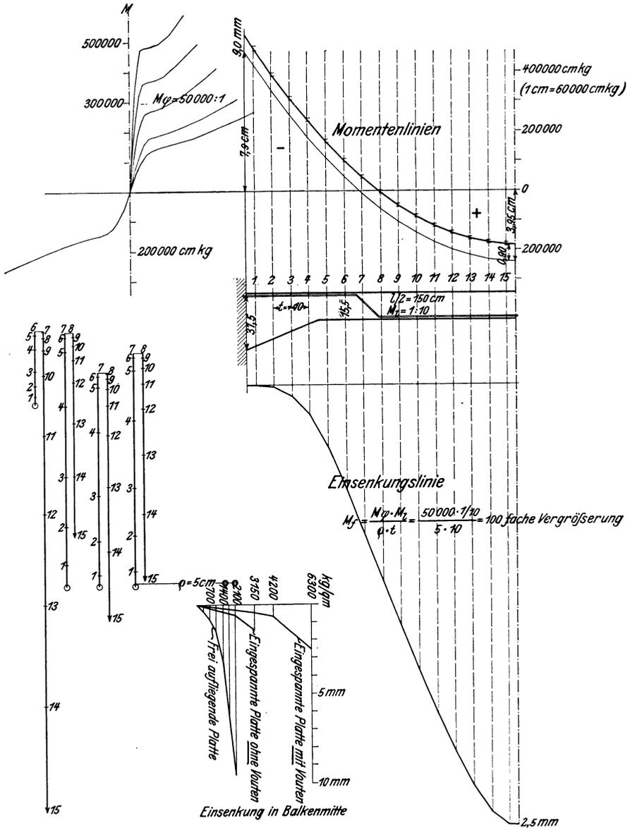
Fig. 33. Eingespannte Platte bei Belastung 6300 kg/qm.
