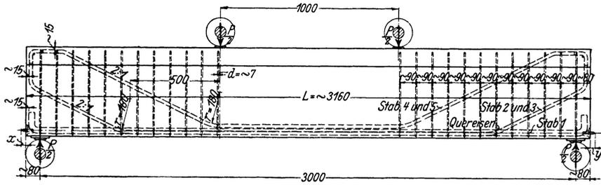
Fig. 25. Plattenbalken Nr. 82 und 85 nach Bach-Fig. 228.
