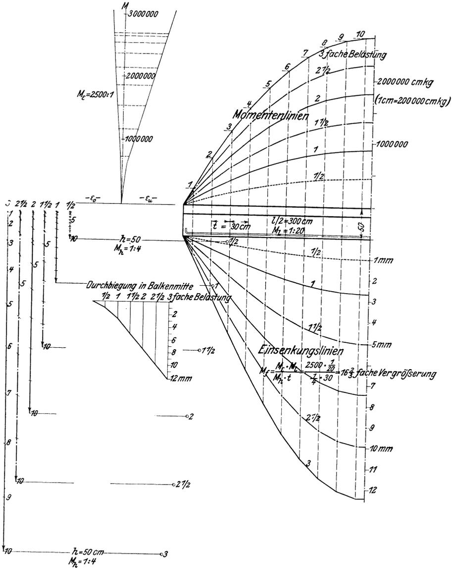
Fig. 36. Einsenkung eines **frei aufliegenden Plattenbalkens** von 6,0 m l. W.
