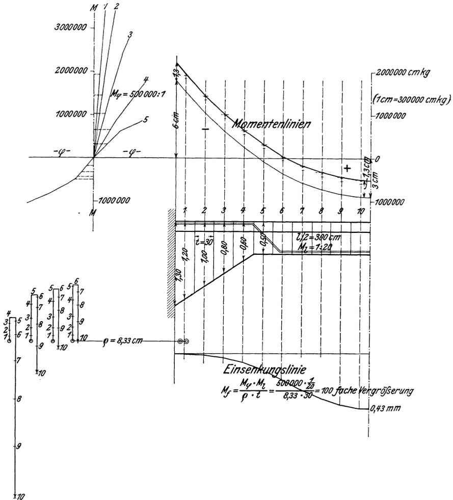
Fig. 37. Fest gespannter Plattenbalken bei Belastung 6000 kg/m.
