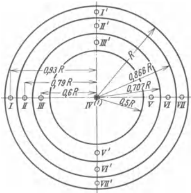
Abb. 238. Teilung eines Rohrquerschnitts in flächengleiche konzentrische Kreise.
