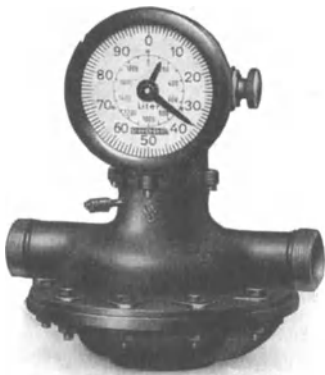
Abb. 218. Scheibenzähler mit senkrecht stehendem Zifferblatt, Zahlenrollenwerk und seitlich rückstellbarem Zeigerwerk (S. & H.).
