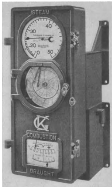
Abb. 95. Kesselschild zur Überwachung der „Verbrennungsgüte“ (Kent). Anzeige für: Dampfmenge, Verhältnis Dampfmenge : Luftmenge, Zug. Registrierung von: Dampfmenge, Verhältnis Dampfmenge : Luftmenge, Rauchgastemperatur.
