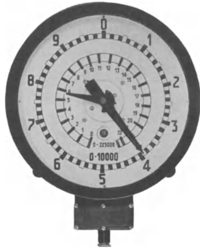
Abb. 314. Gas- und wasserdichter Empfänger mit Grob- und Feinteilung für Anzeige von 225 000 m 3 in Stufen von 100 zu 100 m 3 (Neufeldt & Kuhnke).
