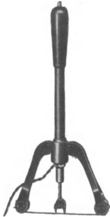
Abb. 187. Anlege-Pyrometer für umlaufende Walzen u. ä. (S. & H.).
