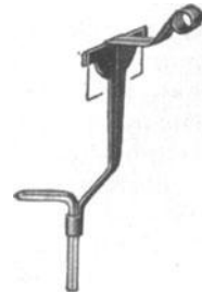
Abb. 66. Saugrohrschreibfeder aus Glas (H. & B.).
