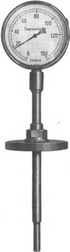
Abb. 168. Zeigerthermometer mit starrem Flanschanschluß für Flüssigkeitsdruck (DRD).
