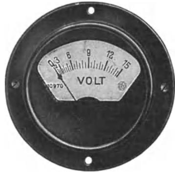
Abb. 371. Elektromagnetisches Voltmeter von Dr. S. Guggenheimer A.-G. Type E<sub>1</sub> oder P<sub>1</sub>.
