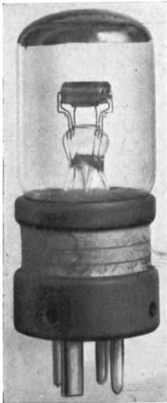
Abb. 243. Empfangsaudionröhre von Telefunken.
