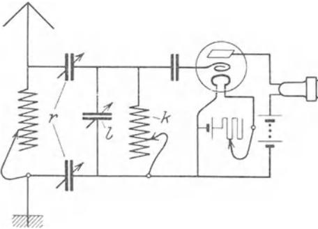
Abb. 107. EN 15. Primär-Sekundär-Audion-schaltung mit kapazitiver Ankopplung des Sekundärkreises.
