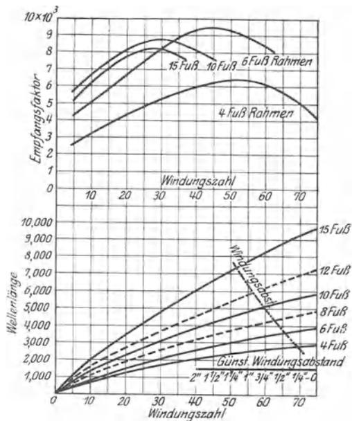
Abb. 141. Empfangslautstärken und Windungsdaten usw. bei Rahmenantennen.
