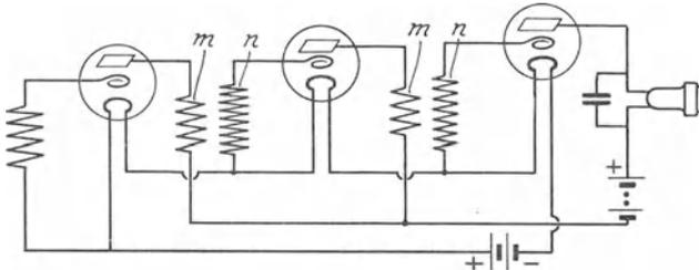
Abb. 150. Stromübertragungskopplung.
