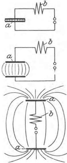
Abb. 53. Entwicklung des offenen aus dem geschlossenen Schwingungssystem.
