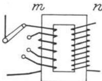
Abb. 251. Eingangstransformator mit stufenweise schaltbarer Primärwicklung.
