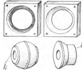
Abb. 351. Einzelteile eines Amateurvariometers zur Selbstanfertigung (Radio Supplies Co. in London).
