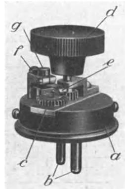
Abb. 220. Einfache Stellzelle (einregulierbarer Kristalldetektor) von G. Seibt.
