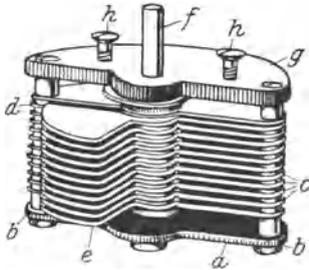
Abb. 180. Prinzipielle Konstruktionsanordnung eines Drehkondensators.
