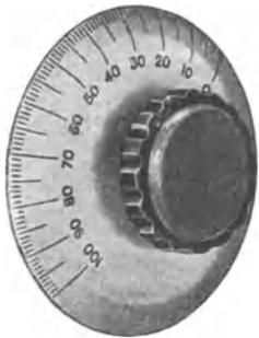
Abb. 316. Skala und Knopf für kontinuierlich variable Apparate aller Art.
