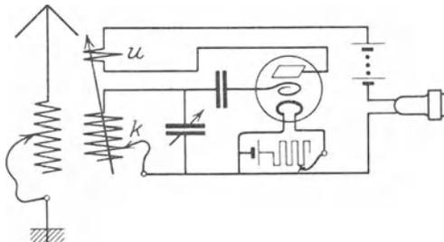
Abb. 110. *EN 18*. Rückkopplungsschaltung zum Empfang ungedämpfter Schwingungen.
