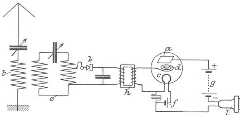
Abb. 154. Niederfrequenzverstärkung.
