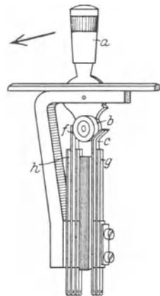
Abb. 301. Hebelschalter (Kellogsschlüssel).
