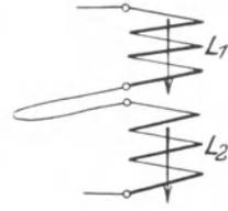
Abb. 203. Bei Spulennäherung nimmt die Selbstinduktion weiterhin zu.
