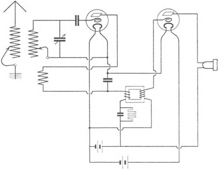
Abb. 124. EN 32. Schwingungsempfangsverstärker.
