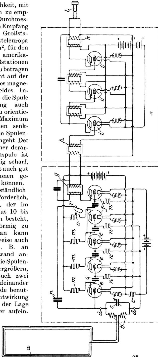
Abb. 85. Röhrenempfängerverstärker von P. Floch, W. de Colle u. E. Nesper.
