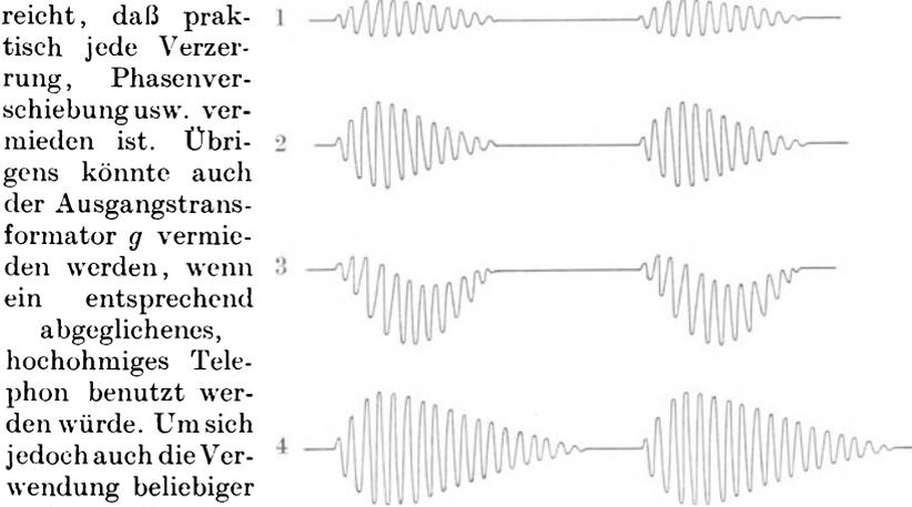
Abb. 86. Schwingungsvorgänge im Röhrenempfängerverstärker.
