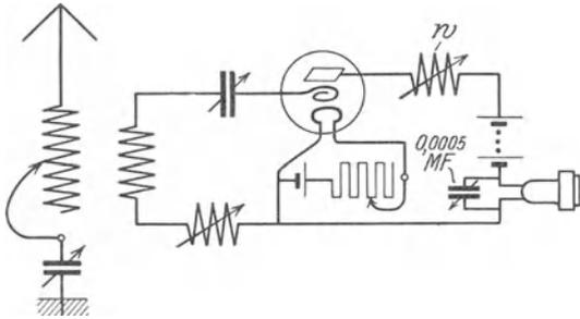
Abb. 112. EN 20. Rückkopplungsschaltung für sehr kleine Wellenlängen.
