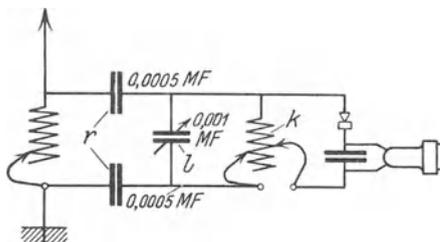
Abb. 103. *EN 11*. Primär-Sekundärempfänger mit kapazitiver Ankopplung des Sekundärkreises und variabler Detektorankopplung.
