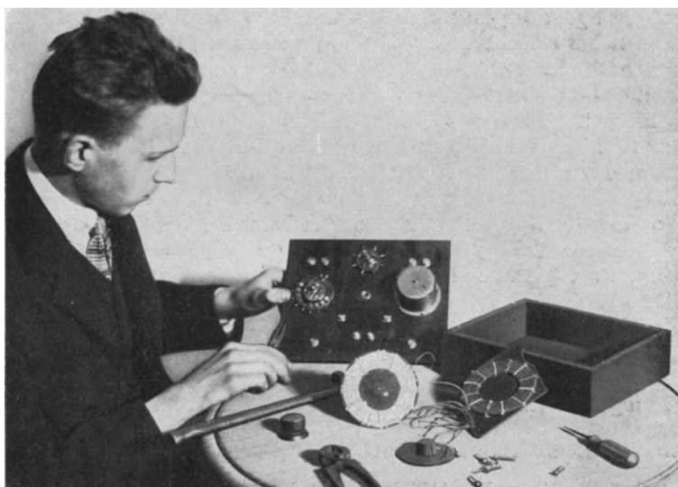
Abb. 337. 3. Stadium: An der Schaltplatte sind von der Rückseite aus die Kontaktbahnen und der Drehkondensator sowie die schon im Stadium 2 erwähnten Kontakt- und Schaltelemente angebracht.
