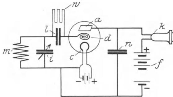
Abb. 224. Prinzipielle Schaltmöglichkeit der Röhre als Detektor.
