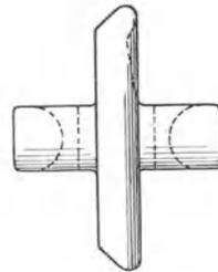
Abb. 134. Antennendrahtisolator für Empfangszwecke (Bullers Ltd., London).
