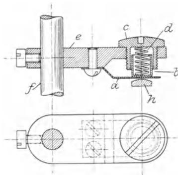
Abb. 299. Druckknopfkontaktvorrichtung.
