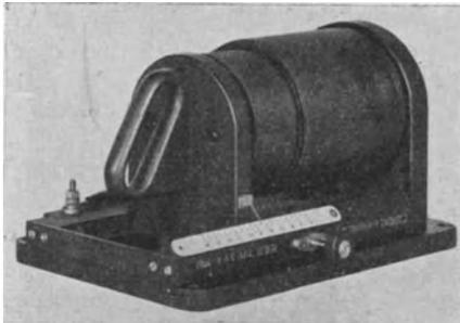
Abb. 204. Selbstinduktionsvariometer mit gegeneinander bzw. ineinander verschiebbaren Spulen. Kann bei entspr. Schaltung auch zu Kopplungszwecken dienen.
