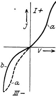
Abb. 216. Symmetrische Charakteristik (Kurve a). Erzwangene Unsymmetrie (Kurve b).
