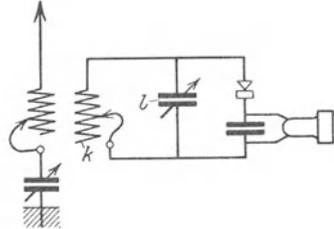
Abb. 99. EN 7. Primär-Sekundär-Kristalldetektorempfänger für kleine und mittlere Wellenlängen.
