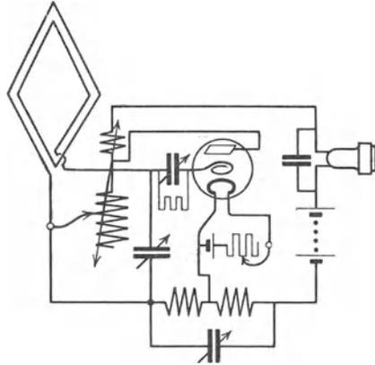
Abb. 129. EN38. Armstrongs Supergenerativschaltung mit einer Röhre.
