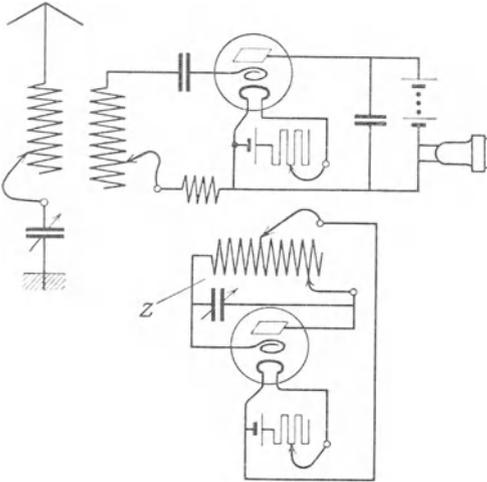
Abb. 118. *EN 26*. Schwebungsempfangsschaltung mit besonderem Schwebungszusatz.
