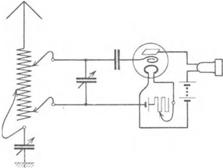
Abb. 106. EN 14. Primär-Sekundär-Audion-schaltung mit dreiseitiger Schiebepule.
