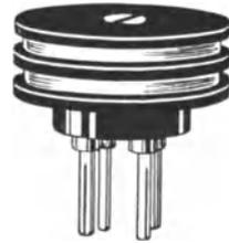
Abb. 255. Leicht auswechselbarer eisenloser Kopplungstransformator.
