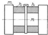
Abb. 256. Widerstandskopplungsspule.
