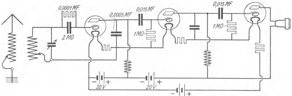
Abb. 123. EN 31. Zweifach-Audiofrequenzverstärker-Empfangsschaltung mit Drosselspulenkopplung.
