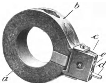
Abb. 197. Honigwabenspule (Honeycomb coil), die in Amerika außerordentlich verbreitet ist.
