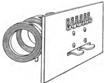
Abb. 332. Spulenpanel von vorn gesehen. Mit den herausragenden Griffen werden die rechte und linke Spule bewegt und wunschgemäß gekoppelt.
