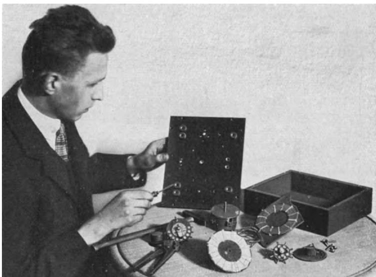
Abb. 336. 2. Stadium: In die Schaltplatte sind die Anschlußbuchsen, Achslager usw. eingesetzt.
