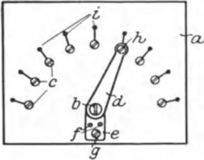
Abb. 349. Kontaktplatte, z. B. für eine Stufenspule.
