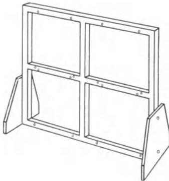
Abb. 326. Gestell für die Panelplatten des Radiobaukastens.
