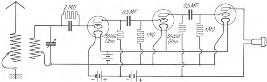
Abb. 122. EN 30. Audiofrequenzverstärker-Empfangsschaltung mit Widerstandskopplung.
