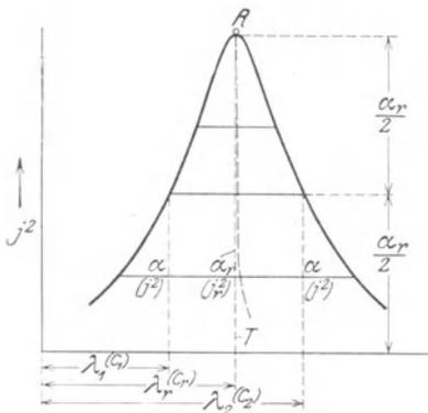
Abb. 33. Aufgenommene Resonanzkurve in einem relativ schwach gedämpften Resonanzsystem.
