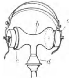
Abb. 163. Rohr-T-Stück mit einem Doppelkopftelephon verbunden.
