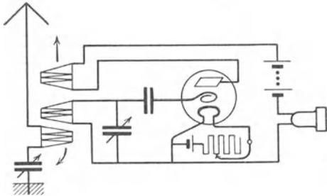
Abb. 113. EN 21. Rückkopplungsschaltung unter Benutzung von Honigwabenspulen.
