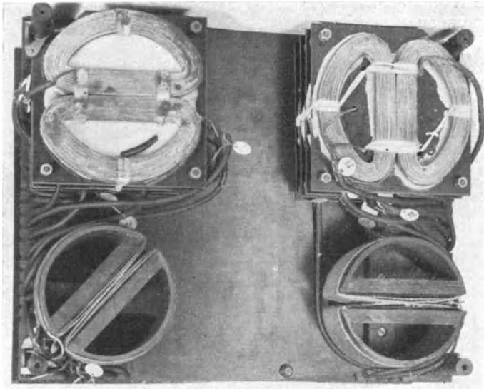
Abb. 194. Anordnung, um die Induktion von Spulen aufeinander tunlichst gering zu halten.
