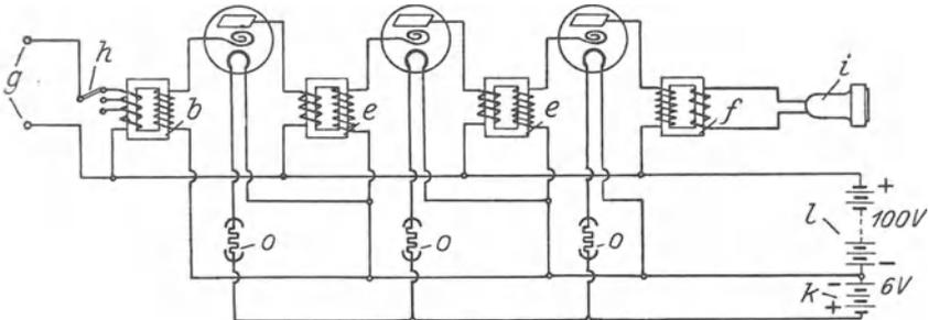
Abb. 158. Schema des Dreiröhrenniederfrequenzverstärkers.
