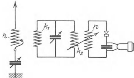
Abb. 101. *EN 9*. Primär-Sekundär-Kristalldetektorschaltung mit geteilter Sekundärkreisspule und variabler Detektoran-kopplung (Marconiempfangsschaltung).
