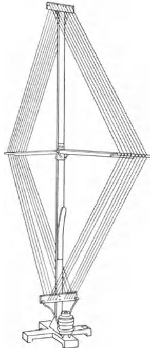
Abb. 140. Leicht beweglicher Zimmerrahmen mit Abstimmungskondensator am Fußende.
