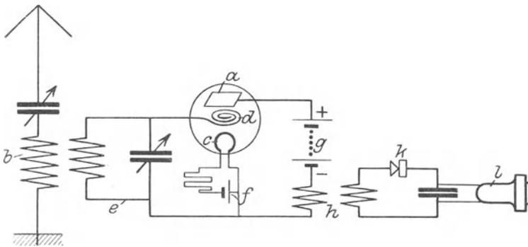
Abb. 147. Hochfrequenzverstärkung.
