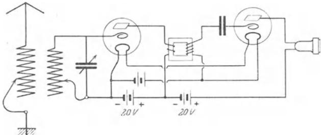
Abb. 125 a. EN 33. Radiofrequenzverstärker-Audiofrequenzverstärker.
