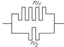
Abb. 38. Zwei Ohmsche Widerstände parallel geschaltet.
