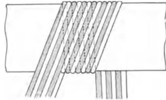
Abb. 195. Wicklungsart von Telefunken für flachgedrückte bandförmige Litzen.
