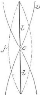
Abb. 54. Hertzscher Oszillator. Sinusförmige Verteilung von Strom und Spannung.
