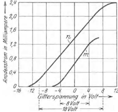
Abb. 157. Charakteristiken für Verstärkeröhren.
