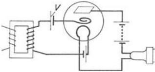
Abb. 155. Vorschaltung einer Spannungsquelle vor das Gitter.
