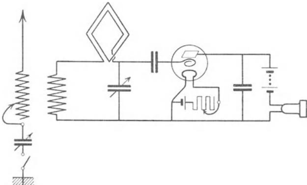
Abb. 120. *EN 28*. Einseitig gerichteter Empfang mit Hochantenne und Rahmenantenne. Abgeblendete Antenne.
