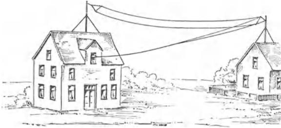
Abb. 131. Ungünstige Anordnung einer L-Antenne.
