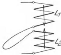
Abb. 206. Spulenfelder gegeneinander gerichtet, Selbstinduktion ein Minimum.
