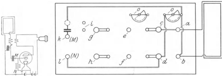
Abb. 325. Röhrenschtaltung mit Rahmenantenne.
