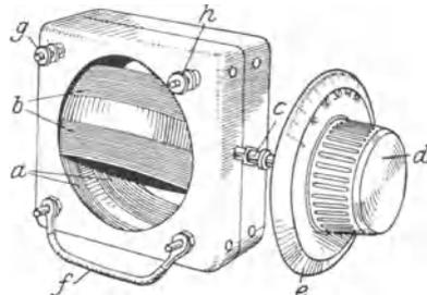
Abb. 208. Prinzipielle Anordnung eines Selbstinduktionsvariometers mit kugelkalottenförmigen Wicklungskörpern, Achse, Knopf und Skala; kann bei entspr. Schaltungsänderung von  $f$  auch zu Kopplungszwecken benutzt werden.
