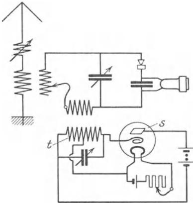
Abb. 104. *EN 12*. Schwebungsempfangsschaltung mit besonderem Röhrgeneratorkreis und Kristalldetektorempfang.
