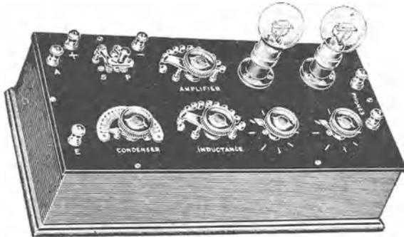
Abb. 82. Zwei-Röhren-Musikempfängerverstärker der Medical Supply Association Ltd., London.
