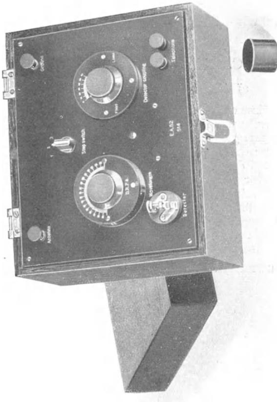
Abb. 76. Abstimmfähiger Kristalldetektorempfänger mit variabler Detektor-
