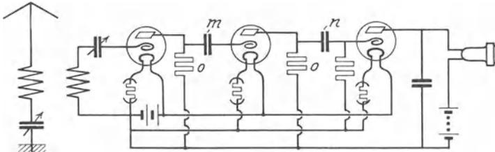
Abb. 152. Dreifach-Hochfrequenzverstärker mit Spannungstransformation.
