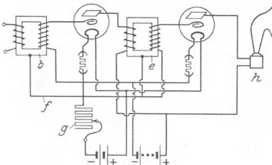
Abb. 159. Zweifachniederfrequenzverstärkeranordnung mit angeschlossenem Lautsprecher von G. Seibt.
