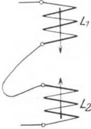
Abb. 200. Beide Spulen in Serie geschaltet, der Wicklungssinn, bzw. die Stromrichtung in beiden entgegengesetzt.
