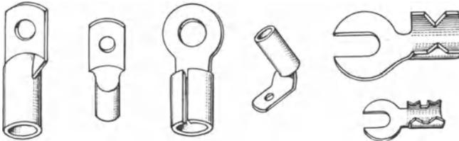
Abb. 318. Anschlußkontaktösen und Kabelschuhe für Kabel, Litzen usw.
