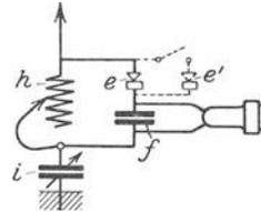
Abb. 94. EN 2. Primär-Kristalldektorschaltung mit Schiebespule<sup>1)</sup> als Abstimmittel für kurze Wellen und fester Detektorankopplung.
