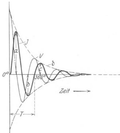
Abb. 28. Bild des gedämpften Schwingungsvorganges im quasistationären Schwingungskreis.
