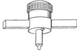
Abb. 305. Englischer Schleifkontakt für Schiebepulen.
