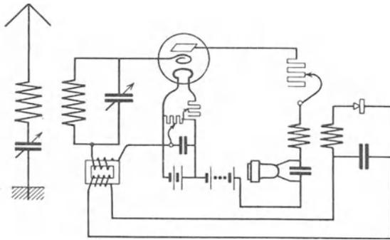
Abb. 127. *EN 36*. Einfache Reflexschaltung mit Hochfrequenz- und Niederfrequenzverstärkung.
