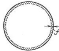
Abb. 190. Eindringungstiefe der Wellen in den Leiterquerschnitt.
