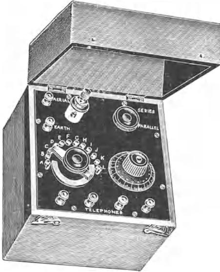
Abb. 75. Kristalldetektorempfänger mit geschlossenem Schwingungskreis der Radio-Instruments Ltd., London.
