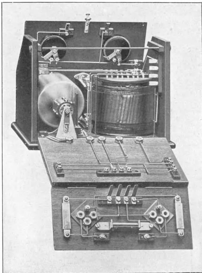
Abb. 81. Hochfrequenzverstärker-Audionempfänger von Kramolin in auseinandergeklapptem Zustand.
