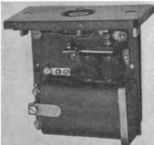
Abb. 368. Prüfsummeranordnung (geöffnet).
