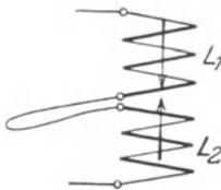
Abb. 201. Resultierende Selbstinduktion  $L_{\text{ges}}$  ein Minimum.
