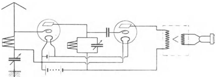
Abb. 125 b. EN 34. Hochfrequenzverstärker — Audionempfänger — Niederfrequenzverstärker.
