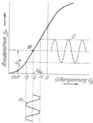
$M$  = Arbeitspunkt,  $J_{FN}$  = Normaler Anodenstrom,  $V_{GN}$  = Normale Gitterspannung,  $m$  = Gitterspannungsvariation,  $o$  = Anodenstromvariation, Anodenspannung = Konstant, Heizstrom = Konstant.
