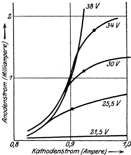
Abb. 231. Anodenstrom-Kathodenstrom-Charakteristik.
