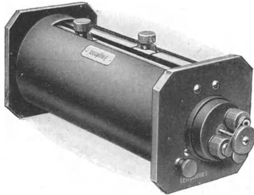
Abb. 70. Einfacher Schiebepulvenempfänger mit Kristalldetektor von G. Seibt.
