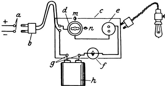
Abb. 365. Einfache Ladevorrichtung bei Gleichstromanschluß für kleine Akkumulatoren, die sich der Radioamateur leicht selbst zusammenbauen kann aus im Handel erhältlichen Zubehöerteilen.
