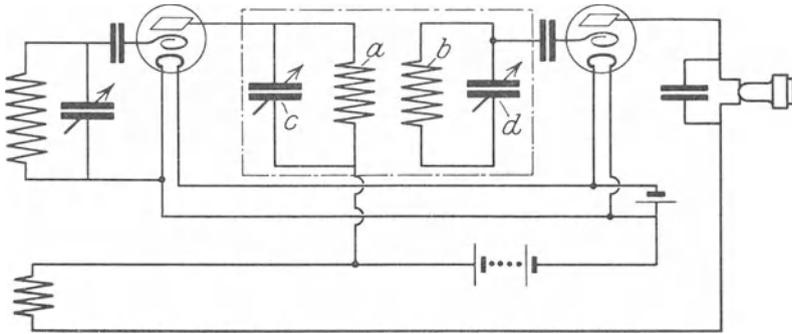
Abb. 148. Eisenlose Kopplungsspulen (abgestimmte Hochfrequenzverstärkerschaltung).
