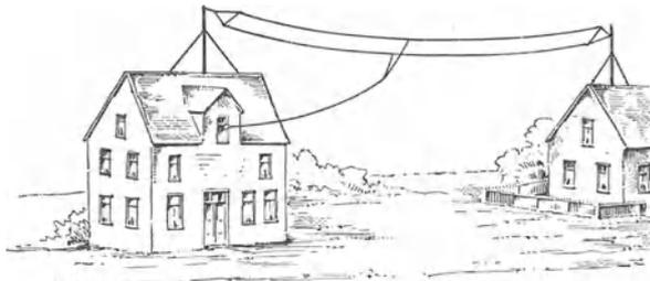
Abb. 130. Richtige Anordnung und Ableitung einer T-Antenne.
