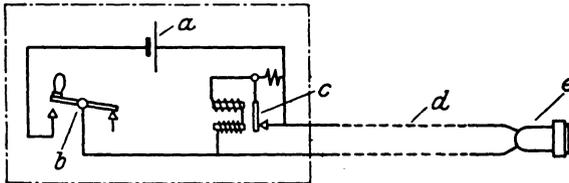
Abb. 376. Schaltschema eines Lehrapparates für Erlernung der Morsezeichen.
