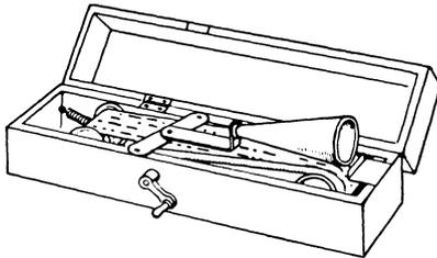
Abb. 377. Lehrapparat mit Handbetrieb für das Senden von Morsezeichen (Boulton, Oxley Bank in Wolverhampton).
