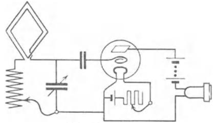
Abb. 119. *EN 27*. Doppelseitig gerichteter Empfang mit Rahmenantenne (Primärkreis).
