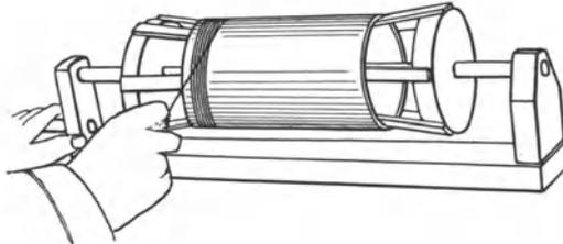
Abb. 342. Bewicklung des Spulenkörpers auf der Maschine (nach Sleeper).
