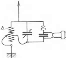
Abb. 96. *EN 4*. Primär-Kristalldetektorschaltung mit Resonanzkreis und variabler Detektorankopplung.
