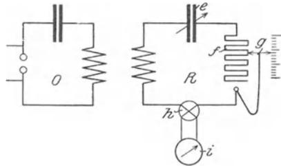
Abb. 34. Dämpfungsmessung eines Resonators mittels variabler Dämpfung desselben.
