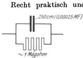
Abb. 275. In Amerika gebräuchliche Parallelschaltung von Ausgleichswiderstand und Gitterkondensator.
