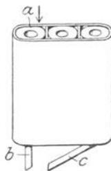
Abb. 361. Auffüllbatterie, insbesondere für Lager- und Exportzwecke.
