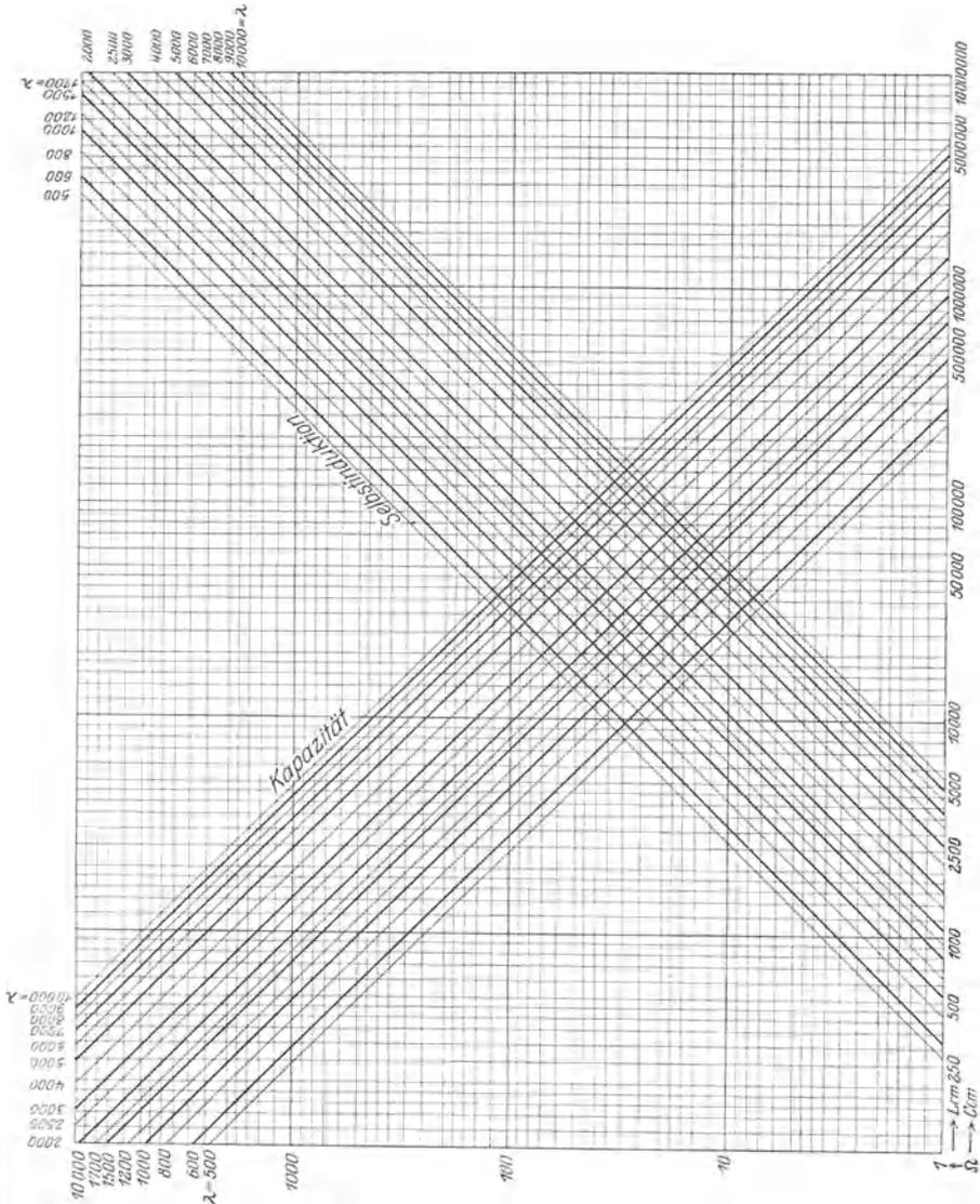
Abb. 45. Wechselstromwiderstände von Kapazitäten und Selbstinduktionen.
