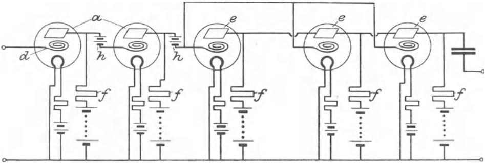
Abb. 151. Mehrfachverstärker mit Widerstandsspannungssteigerung von L. de Forest-Arnold.
