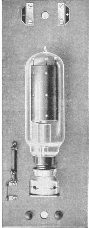
Abb. 367. Glimmlichtgleichrichteranlage mit einer Edelgaslampe des Hydrarwerkes.
