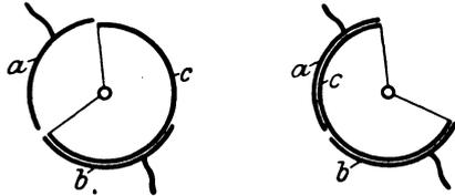
Abb. 187. Veränderlicher Kondensator für sehr kleine Kapazitätsbeträge.
