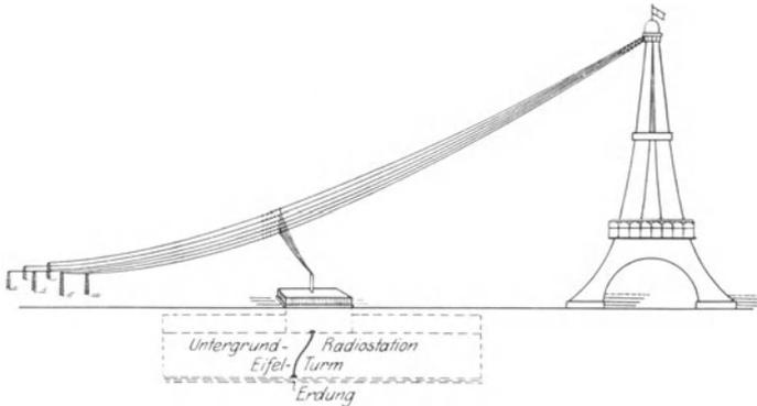
Abb. 69. Anordnung der Eifelturmstation und der Antenne.
