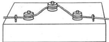
Abb. 343. Drahtstreckanordnung, um den Wicklungsleiter ohne Kinke auf den Spulenkörper aufzubringen.
