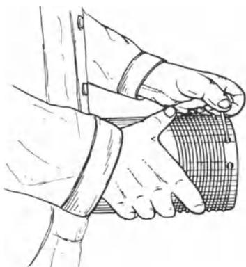
Abb. 340. Wicklung einer Spule von Hand.
