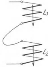
Abb. 202. Wicklungssinn, bzw. Stromrichtung in der unteren Spule umgekehrt.
