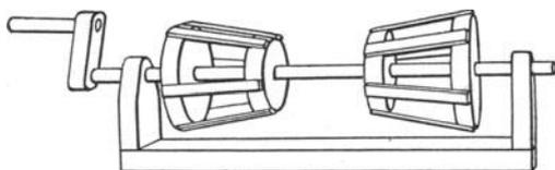
Abb. 341. Einfache kleine Maschine zur Wicklung von Zylinderspulen.
