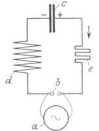
Abb. 27. Geschlossener quasistationärer Schwingungskreis.
