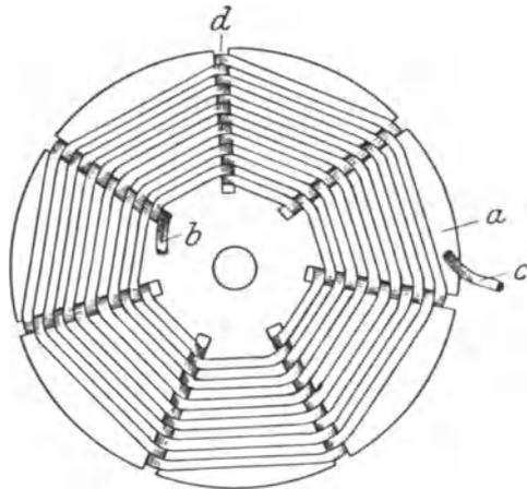
Abb. 198. Spiralförmige Schlitzspule.
