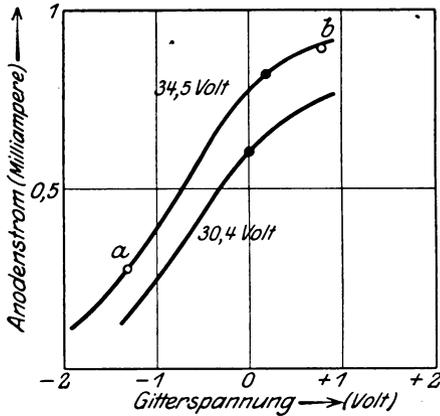
Abb. 229. Anodenstromcharakteristik.
