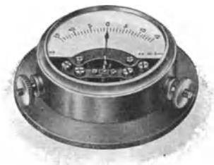
Abb. 375. Galvanoskop von Siemens & Halske A.-G.
