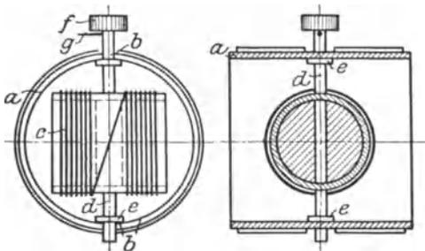
Abb. 350. Selbstinduktionsvariometer bzw. Kopplungsvorrichtung.
