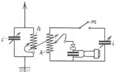
Abb. 100. *EN 8*. Primär-Sekundär-Kristalldetektorempfänger für alle Wellenlängen mit einregulierbarer [Detektorkopplung.
