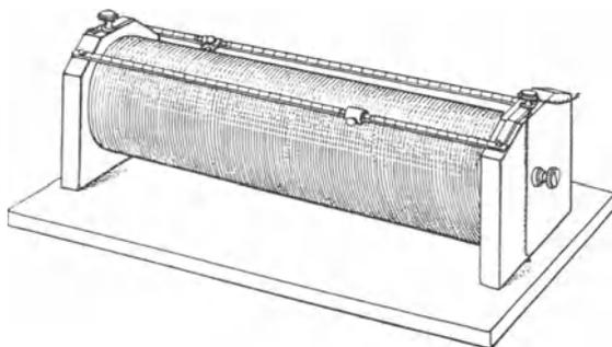
Abb. 199. Schiebespule mit zwei Kontakten (Schiebern, Schleifern).
