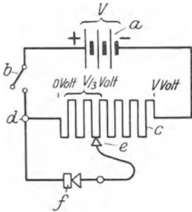
Abb. 39. Potentiometer (Spannungsteiler).
