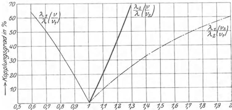
Abb. 31. Ablesung des Kopplungsgrades aus dem Verhältnis der Wellenlängen bzw. Frequenzen.
