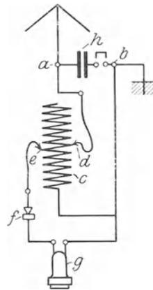
Abb. 71. Schaltungsschema des einfachen Kristalldetektor-Schiebepulvenempfängers von G. Seibt.
