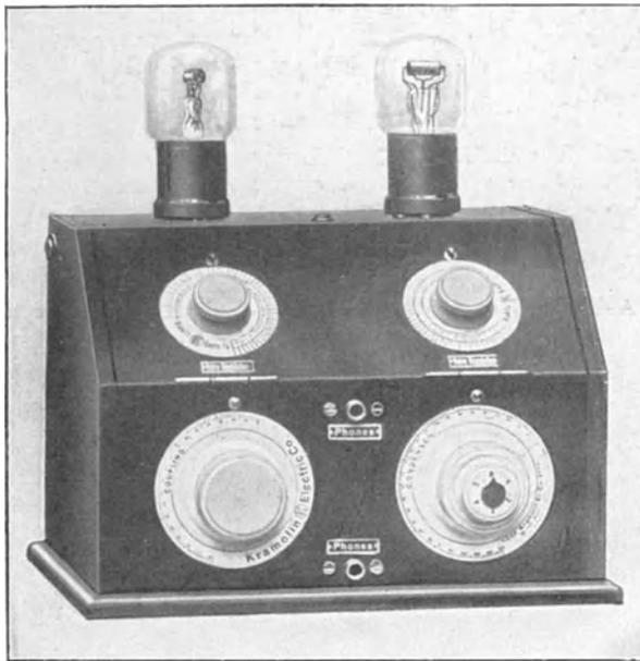
Abb. 80. Hochfrequenzverstärker - Audionempfänger von Kramolin im gebrauchsfertigen Zustand.
