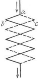
Abb. 260. Kapazitäts- und selbstinduktionsloser Widerstand von Ruhstrat.
