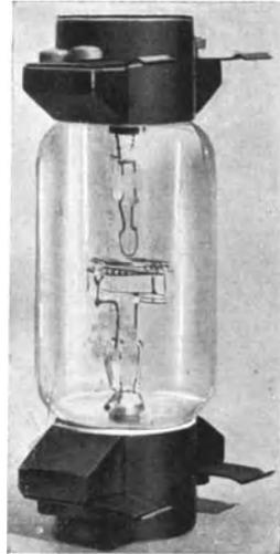
Abb. 242. Ältere Empfangs-Verstärkerröhre der AEG.
