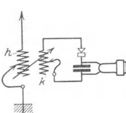
Abb. 98. EN 6. Primär-Kristalldetektorschaltung mit Schiebepulsen.
