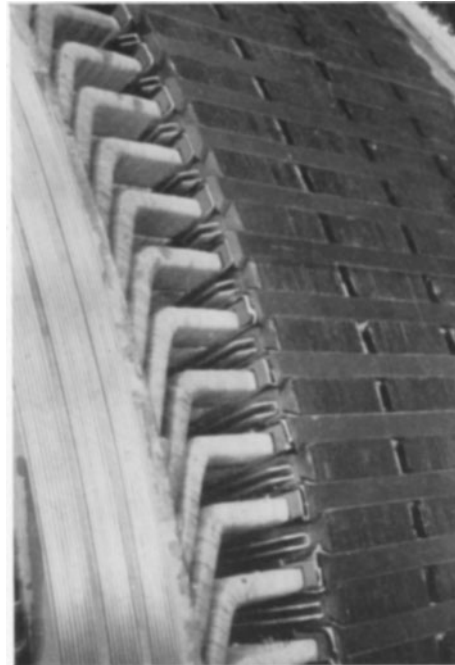
Bild 30. Fertig gewickelter Nutendämpferanker eines Gleichstromdynamos für 4000 kW-Spitzenleistung und 600 U/min.
