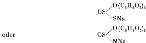
übergegangen. Dann läßt man das erhaltene Gerinnsel in dünnem Strahl in eine Salzlösung einfließen, wobei sich die Verunreinigungen lösen, während die Xanthogenate ungelöst bleiben. Das unlösliche Produkt läßt man eine Zeitlang in der Salzlösung, damit sich alle Verunreinigungen durch Dialyse auflösen, worauf man das Xanthogenat von der Flüssigkeit trennt und mit Wasser wäscht.
