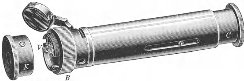
Abb. 13 a. Spektroskop nach VOGEL. (Aus NEUBERG: Der Harn.)
