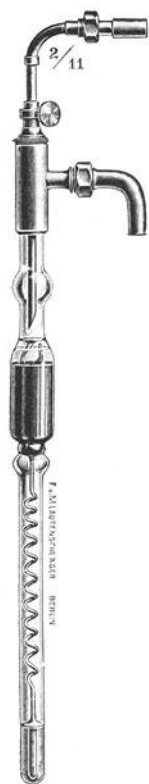
Abb. 3. Thermoregulator für Gas.
