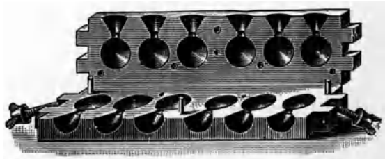
Abb. 143. Gußform für Vaginalkugeln von Rob. Liebau-Chemnitz.
