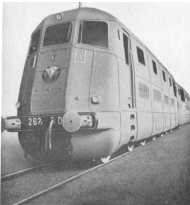
Abb. 108. 4000 PS diesel-elektrische Lokomotive der P. L. M.
