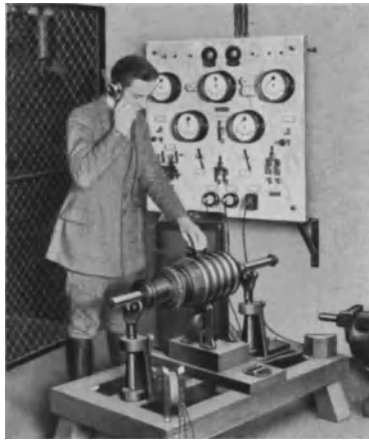
Abb. 218. Ankerprüfeinrichtung im Betrieb (Werkbild Siemens).
