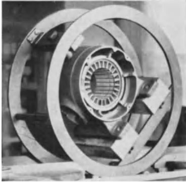
Abb. 166. Wickelgestell für kleinere Ständer (Werkbild Garbe-Lahmeyer).
