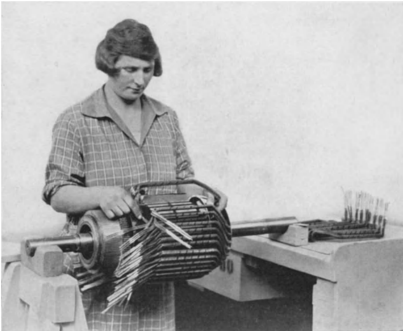
Abb. 58. Einlegen von Ankerspulen in offene Nuten (Werkbild Siemens).
