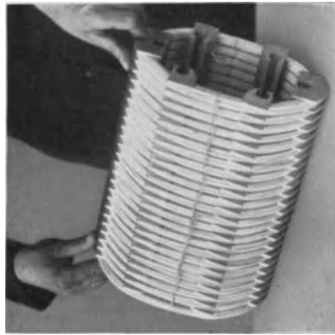
Abb. 169. Wickelform für Spulen gleicher Weite (Werkbild Schümann). a) Gestell, b) Gestell mit fertigem auf Führungsstücke gewickelten Spulensatz, c) abgenommener Spulensatz mit Führungsstücken.
