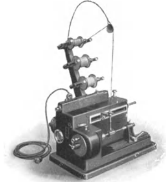
Abb. 74. Wickelmaschine mit pendelnder Drahtführungsdüse (Werkbild Schlegel).
