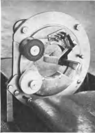
Abb. 196. Umbandelmaschine (Werkbild Siemens).
