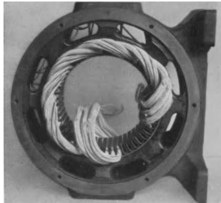
Abb. 137. Dreiphasige Ständerwicklung mit Spulen gleicher Weite während des Einlegens (Werkbild Schumann).
