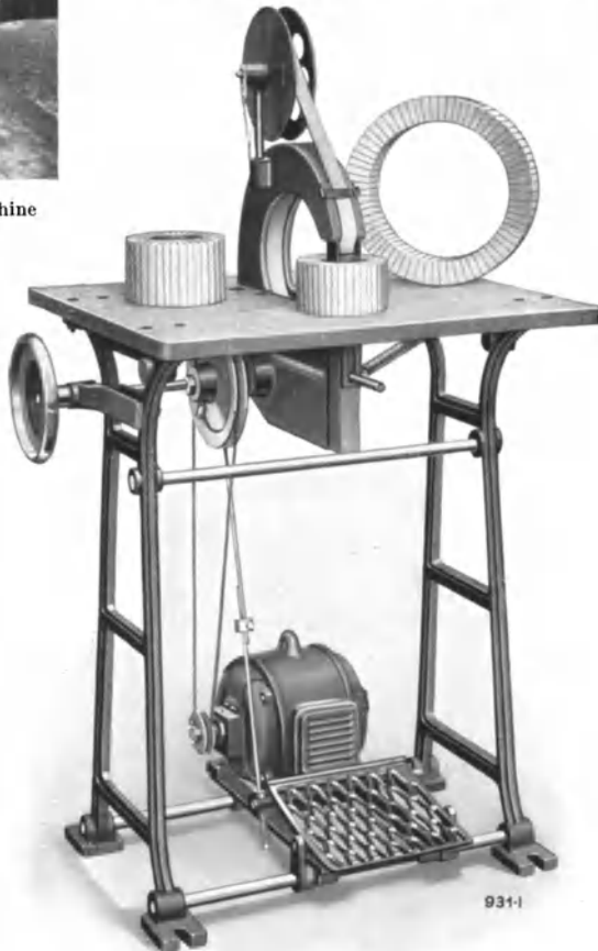
Abb. 197. Umbandelmaschine für Spulen mit kleinem Innendurchmesser (Werkbild Micafil).
