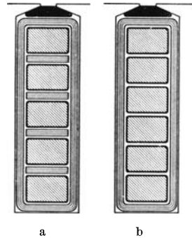
Abb. 202. Verschiedene Isolation von Eingangs- und Innennut (nach Siemens-Z. 1921, S. 21). a) Eingangsnut, b) Innennut.
