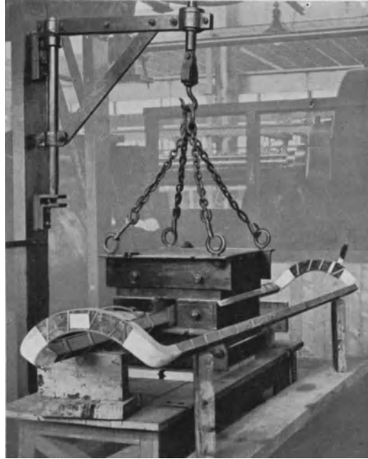
Abb. 216. Prüfen einer Induktorspule auf Windungsschluß (Werkbild Siemens).
