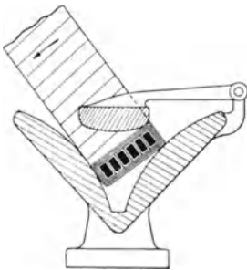
Abb. 206. Schnitt durch die Bügelmulde (mit Spulenseite) der Bügelmaschine nach Abb. 205 (Werkbild Micafil).
