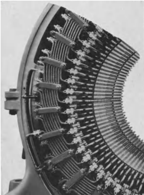
Abb. 147. Einschichtige Stabwicklung als Evolventenwicklung (Werkbild BBC).
