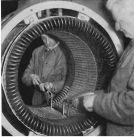
Abb. 175a u. b. Auswechseln einer schadhafter Ständerspule einer Zweischichtwicklung (Werkbild AEG).
