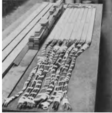
Abb. 183. Bündelspulen (Werkbild Siemens).
