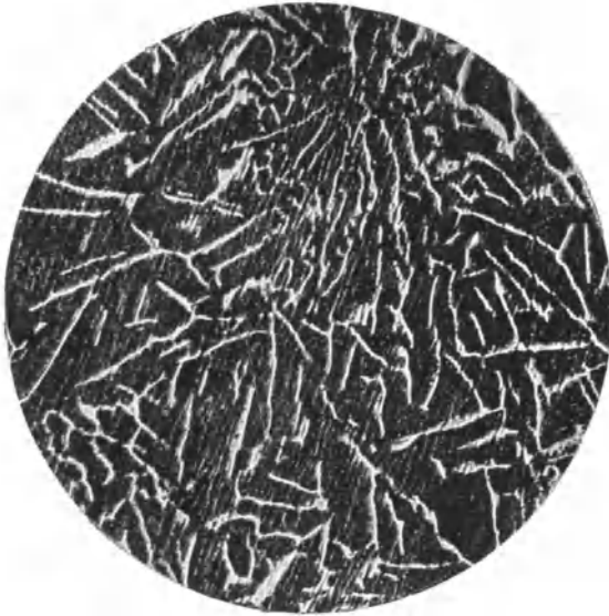
Abb. 99. Geseigertes Einheitsmetall. Detail aus Abb. 97 (Fußende). Geätzt mit heißer Schwefelsäure 1:1. Lineare Vergr. 150.
