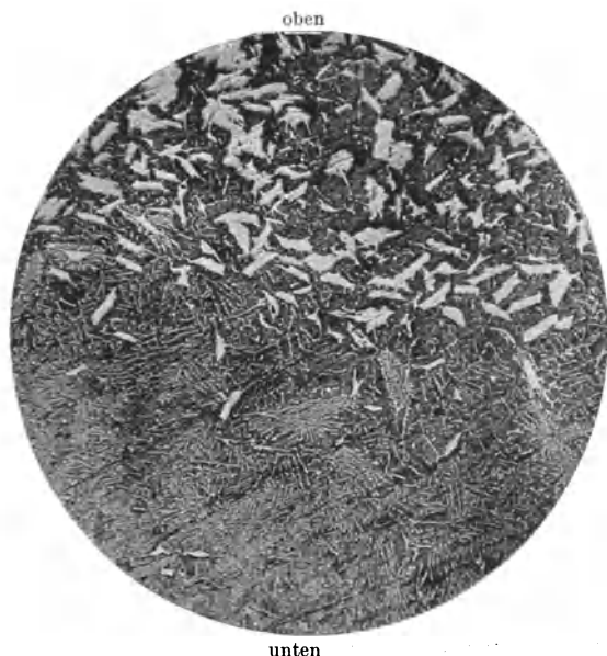
Abb. 97. Geseigertes Einheitsmetall. Geätzt mit heißer Schwefelsäure 1 : 1. Lineare Vergr. 50.
