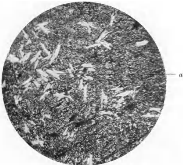
Abb. 15. Verbranntes Einheitsmetall. Geätzt mit Schwefelsäure 1:1. Lineare Vergr. = 250.
