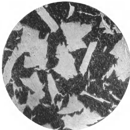
Abb. 98. Geseigertes Einheitsmetall. Detail aus Abb. 97 (Kopfende). Geätzt mit heißer Schwefelsäure 1 : 1. Lineare Vergr. 150.
