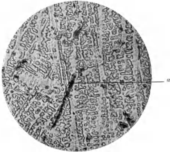
Abb. 7. Probestück, wie bei Abb. 6, aber geätzt. Ätzpoliert mit Ammoniakwattebauch. Lineare Vergr. = 50.
