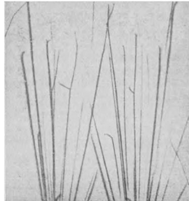
Abb. 29. Zusammenstoß eines \alpha -Teilchens mit einem Wasserstoffkern.
