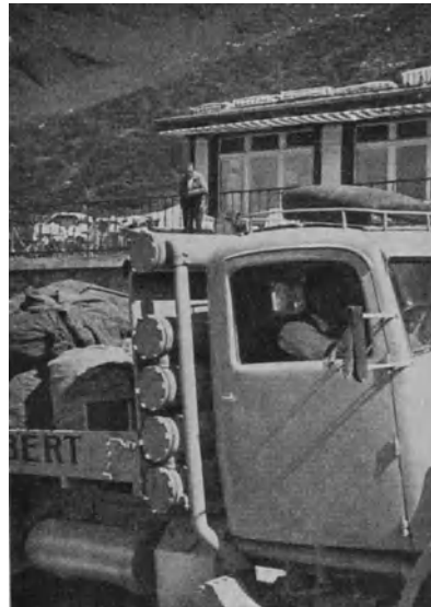
Abb. 47. Einbau der Reiniger hinter dem Führerhaus.
