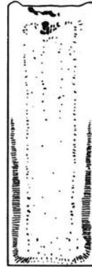
Abb. 147. Normale Anordnung der Gasblasen in unberuhigtem Flußeisen.
