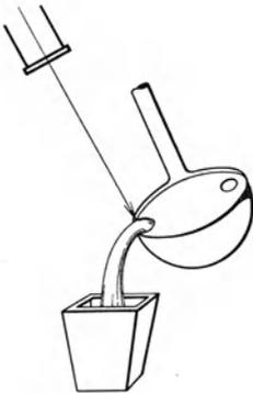
Abb. 4. Gebräuchliche Temperaturmessung im Stahlwerk.
