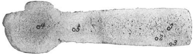
Fig. 46. Querschnitt durch einen richtig getemperten Schlüssel. V=3 .
