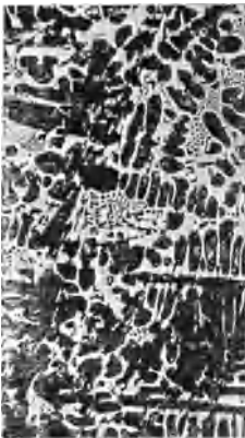
Fig. 38. Gefüge von Temperrohguß. V = 100.
