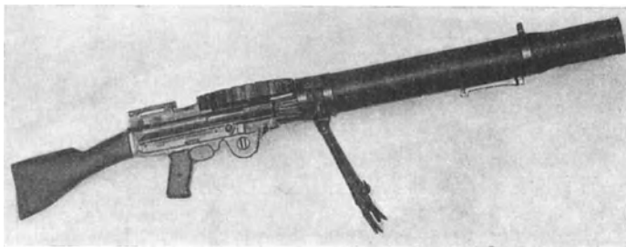
Abb. 37. Lewis-M.G. (Trommelmagazin mit radialer Lagerung der Patronen).
