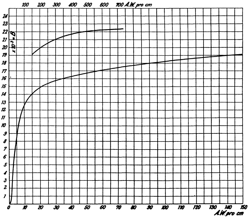
Fig. 70. Magnetisierungskurve für Stahlguß (G. Krautheim).
