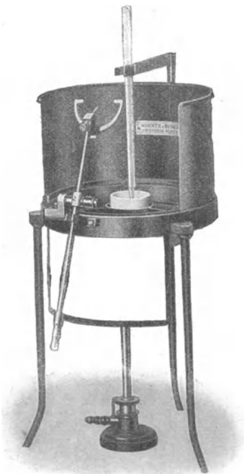
Abb. 33. Flammpunkt-Apparat mit senkrechter Flammenführung (Sommer & Runge).
