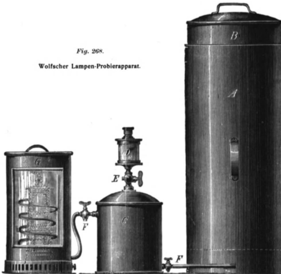
Hierzu dienen zwei ineinander gesteckte Cylinder A und B. A ist oben offen und wird auf  $\frac{2}{3}$  seiner Höhe mit Wasser gefüllt. B ist unten offen und hat auf seiner Decke ein nach dem Innern sich öffnendes Ventil. Oeffnet man dieses durch einen Druck des Fingers und zieht den Cylinder
