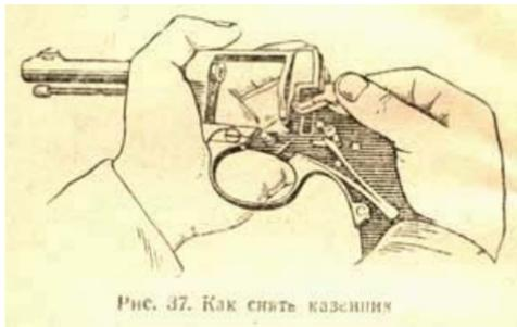
Рис. 37. Как снять казенник
