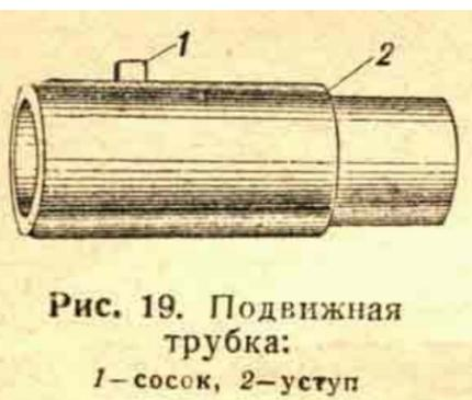
**Рис. 19.** Подвижная трубка:
