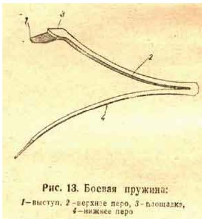
Рис. 13. Боевая пружина:
