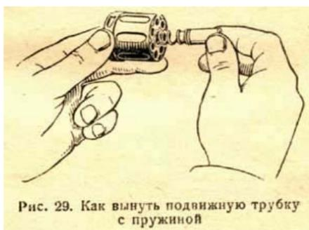
Рис. 29. Как вынуть подвижную трубку с пружиной
