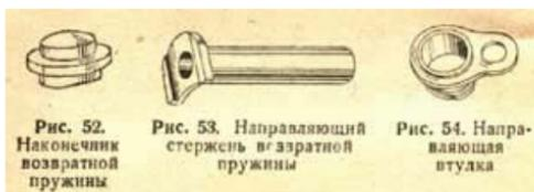
**95. Направляющая втулка** (рис. 54) служит для направления дульной части ствола при движении затвора и упором наконечнику возвратной пружины. Она имеет: на передней части — **фланец**, который прикрывает передний обрез кожуха затвора; на заднем конце — **кольцевую проточку** и **плоско снятые бока** для соединения с кожухом затвора; на нижнем конце — **отверстие** для наконечника возвратной пружины
