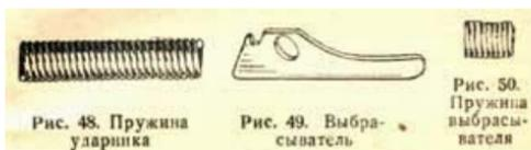
Выбрасыватель имеет: **зацеп**, которым он заскакивает за шляпку гильзы; отверстие для шпильки; **пружину** (рис. 50), которая прижимает передний конец выбрасывателя к затвору и обеспечивает заскакивание его зацепы за шляпку гильзы; пружина помещается в гнезде затвора; **шпильку**, которая помещается в отверстии затвора.
