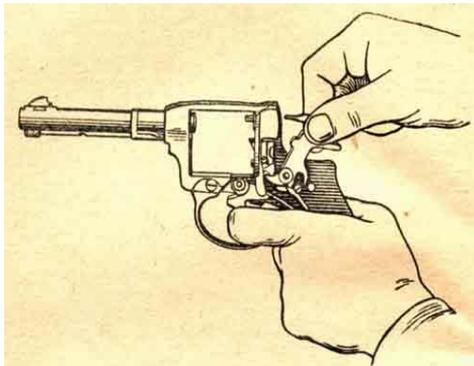
Рис. 33. Как снять курок с оси
