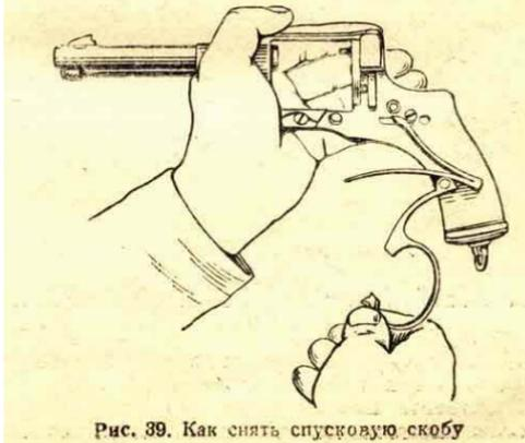
Рис. 39. Как снять спусковую скобу
