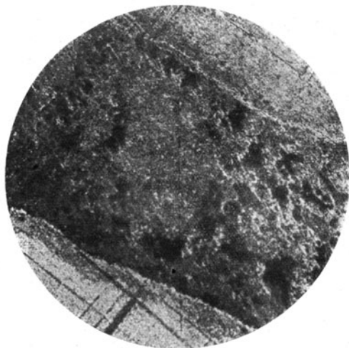
Abb. 36. Schweißfuge, geätzt; \frac{200}{1} Vgr.
