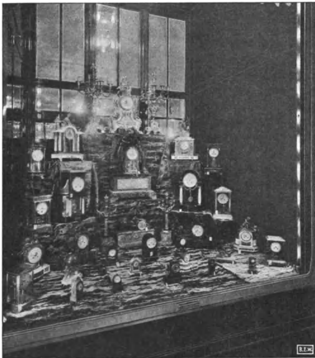
Fig. 58. Schaufensterbeleuchtung mit verdeckt angeordneten Metallfadenlampen (Soffittenbeleuchtung).
