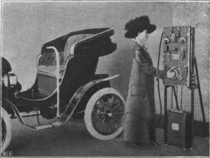
Fig. 83. Elektromobil-Ladestation mit Quecksilber-Gleichrichter.
