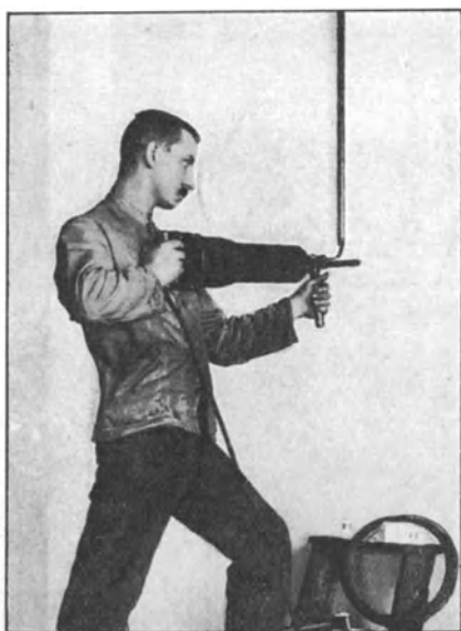
Fig. 99. Einstimmen eines Durchlasses in eine Wand mittels mechanischen Hammers mit direktem elektrischem Antrieb.
