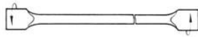
Abb. 12. Verdrehung. Gleitbruch senkrecht zur Längsachse eines verdrehten zähen Stahlstabes. Aufn. M. P. A., Berlin-Dahlem.
