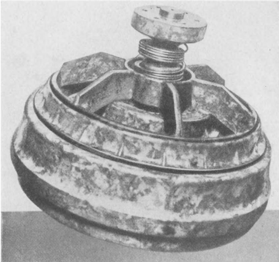
Bild 16a. Ventil aus Kunstharzpreßstoff T2 für Seewasserkolbenpumpen, Außenansicht.
