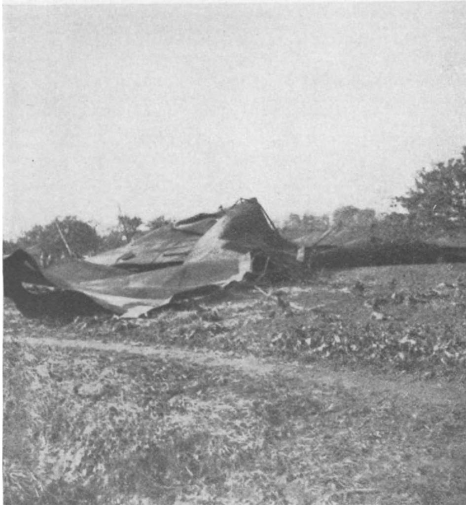
Bild 7. Die vier oberen Blechschusse des Tankmantels mit Ende c-e.
