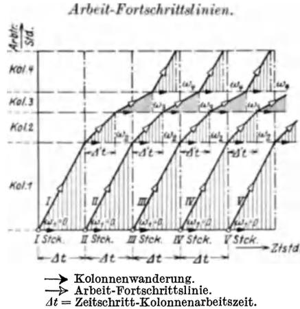
Abb. 2. Fertigung mit Wartezeiten (Hand in Hand-Arbeit).
