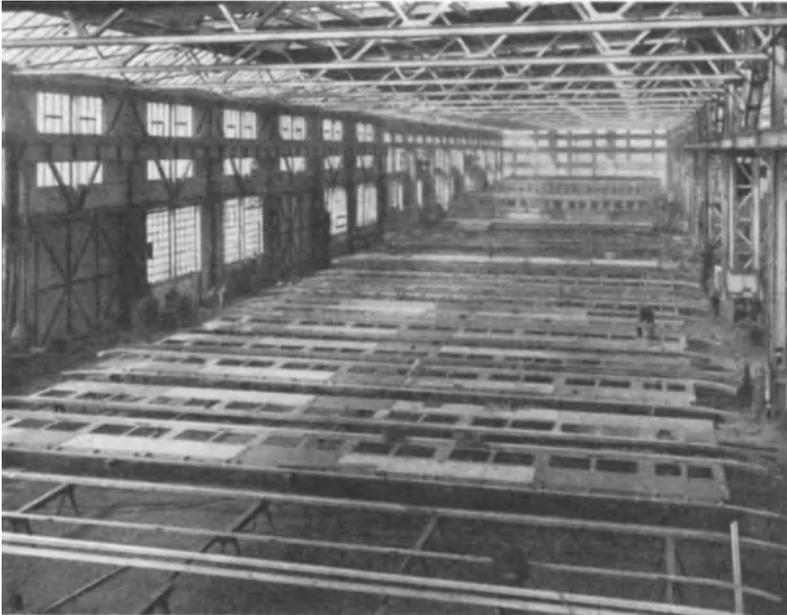
Abb. 1. Reihenfertigung eiserner D-Zug-Wagenrohbauten.
