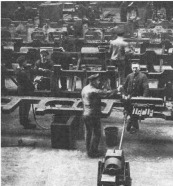
Abb. 5. Bohrarbeiten am Barrenrahmen mittels Schlitten und Preßluftbohrmaschine.
