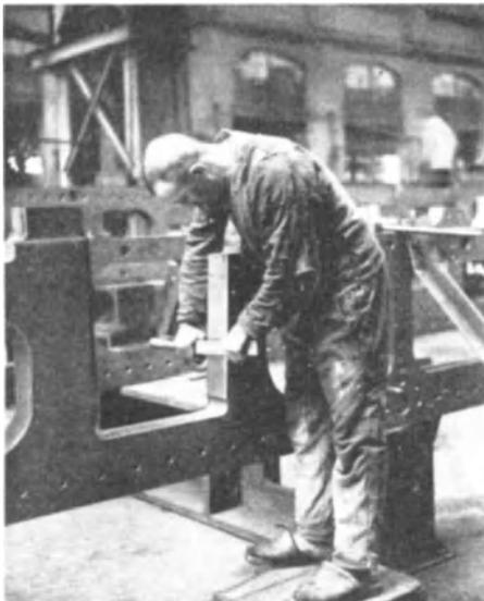
Abb. 26. Arbeitshaltung beim Befellen des Barrenrahmen (Angriffspunkt in Hüfthöhe).
