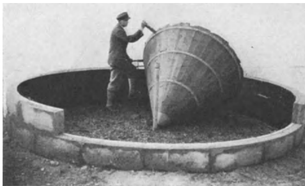
Abb. 319. Elefantensilowalze des HK-Silos zum Pressen des Futters.
