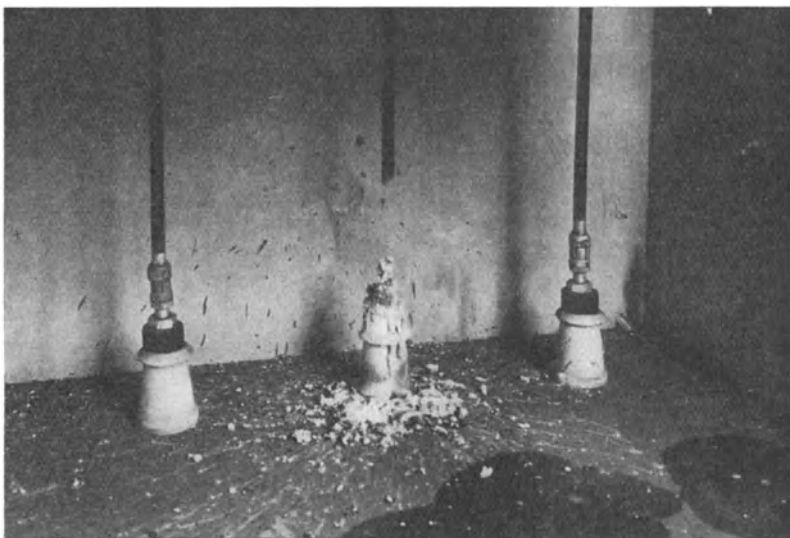
Abb. 255. Verhalten einer schlechten Kontaktstelle beim Kurzschluß.
