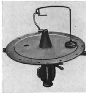
Abb. 2. Schlingenelektrometer und Deckelplatte des Strahlungsapparates. (Nach KOLHÖRSTER.)
