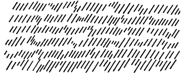
Abb. 214. Schema eines Mischkristalls aus verschiedenen langen Molekülen, von dessen „Ebenen“ nur die niederen Röntgenreflexe merklich stark zu erwarten sind.
