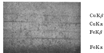
Abb. 117. Nachweis, daß die an einem Eisenkristall unter fast 90^\circ gestreute Interferenzstrahlung (Cu-Strahlung) polarisiert, die in ihm entstandene Fluoreszenzstrahlung unpolarisiert ist. (MARK u. SZILARD, I. c.)
