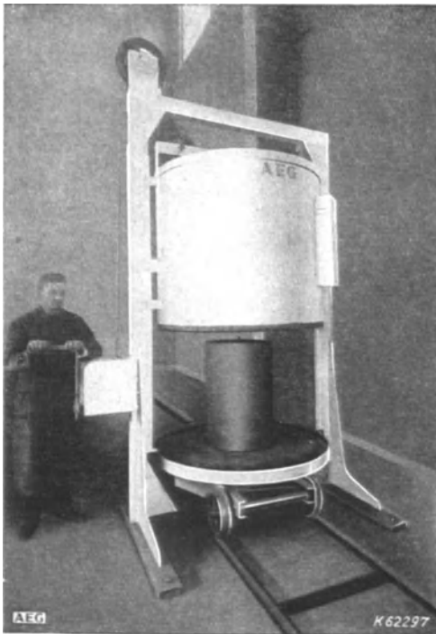
Abb. 130 a. Blankglühofen mit fahrbarem Herd.
