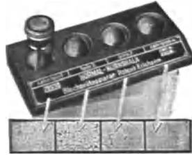
Abb. 2. Normalkornskala DRP. mit Spezialmikroskop zur Korngrößenbeurteilung.
